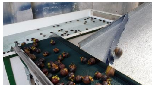
ภาพที่ 11 ระบบลำเลียงมังคุดเข้าถังคัดแยกแบบใหม่
