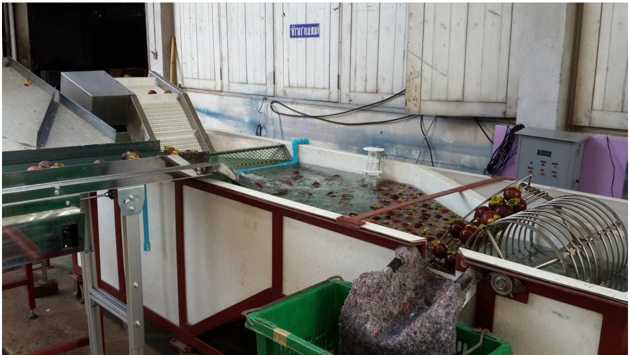
ภาพที่ 26 การทดสอบประสิทธิภาพการคัดแยกของต้นแบบเครื่องคัดแยกคุณภาพผลมังคุดโดยค่าความถ่วงจำเพาะของสารละลายทำงานต่อเนื่อง
