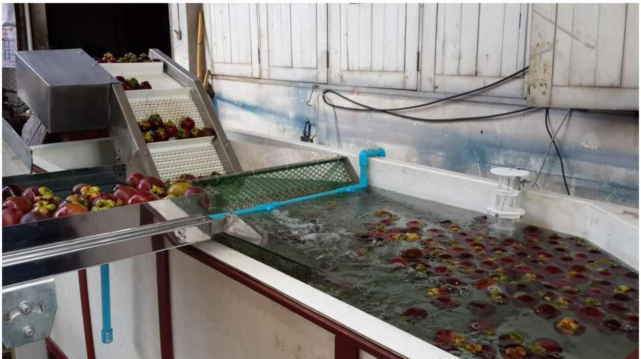
ภาพที่ 28 การทดสอบประสิทธิภาพระบบลำเลียงมังคุดส่วนจมออกจากถังคัดแยก
