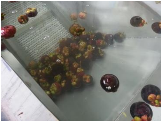
ภาพที่ 16 ระบบลำเลียงมังคุดส่วนจมออกจากถังคัดแยกเบื้องต้น
