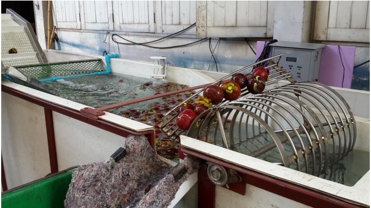
ภาพที่ 27 การทดสอบประสิทธิภาพระบบลำเลียงผลมังคุดส่วนลอยน้ำออกจากถังคัดแยก
