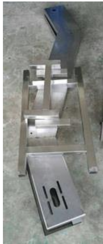
ภาพที่ 14 โครงสร้างของระบบลำเลียงมั่งคุดส่วนจมออกจากถังคัดแยก
