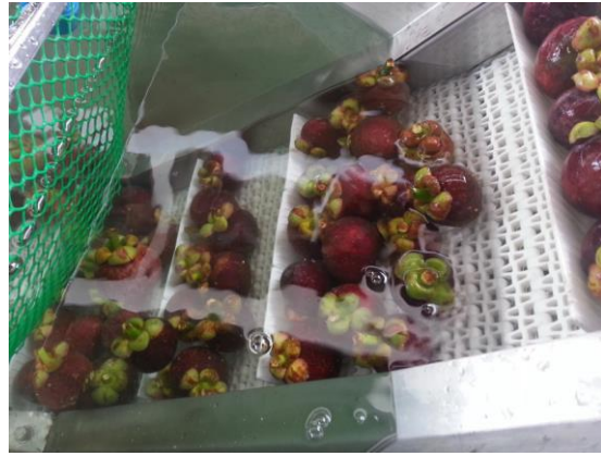
ภาพที่ 18 พลาสติกกระดกได้ป้องกันมังคุดช้ำใบตัด และตะแกรงกันการปนของมังคุดลอย
