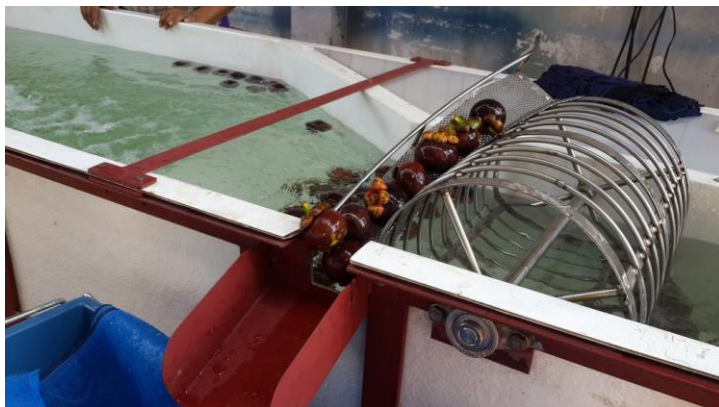
ภาพที่ 21 การทดสอบระบบลำเลียงผลมังคุดส่วนลอยน้ำในถังคัดแยก
