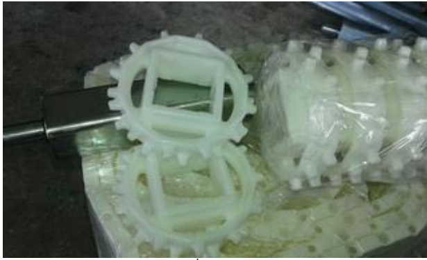
ภาพที่ 15 ล้อฟันเฟืองโพลีพรพิลีน และ สายพานลำเลียงโพลีพรพิลีน
