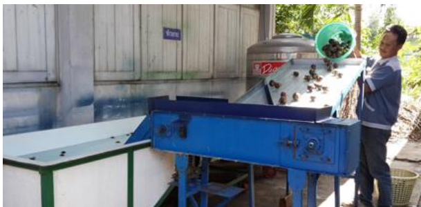
ภาพที่ 10 ระบบลำเลียงมังคุดเข้าถังคัดแยกแบบเก่า
