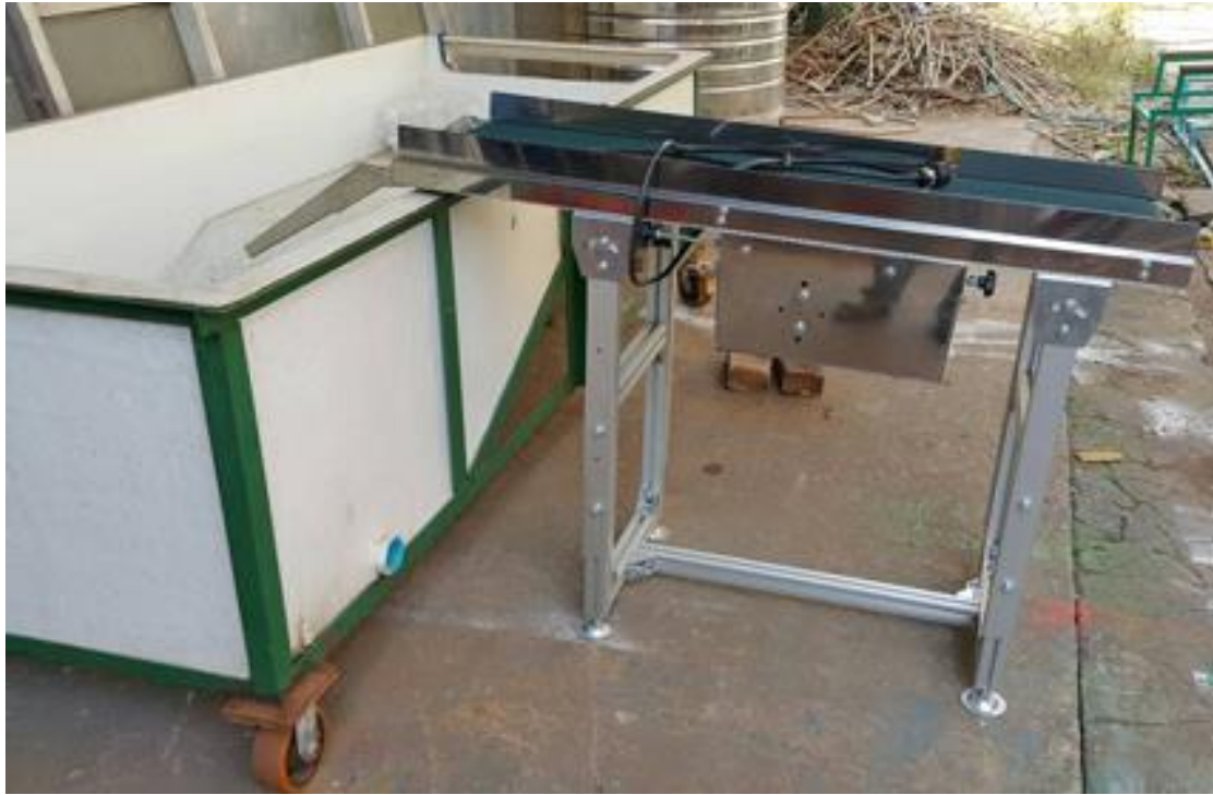
ภาพที่ 9 ต้นแบบระบบลำเลียงมังคุดเข้าถังคัดแยก
