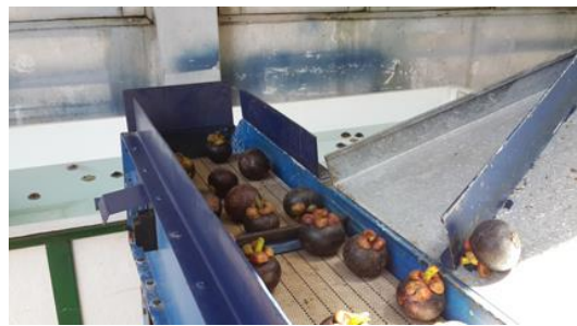
ภาพที่ 10 ระบบลำเลียงมังคุดเข้าถังคัดแยกแบบเก่า
