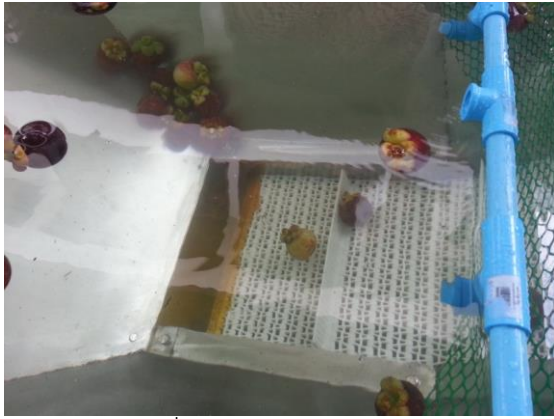
ภาพที่ 18 พลาสติกกระดกได้ป้องกันมังคุดช้ำใบตัด และตะแกรงกันการปนของมังคุดลอย
