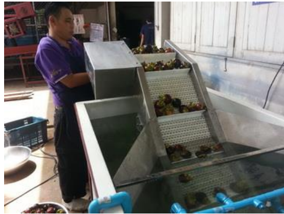
ภาพที่ 16 ระบบลำเลียงมังคุดส่วนจมออกจากถังคัดแยกเบื้องต้น
