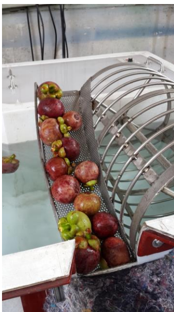
ภาพที่ 21 การทดสอบระบบลำเลียงผลมังคุดส่วนลอยน้ำในถังคัดแยก
