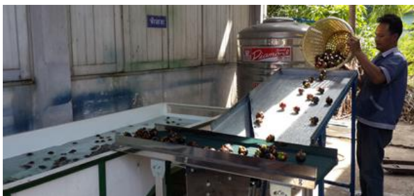
ภาพที่ 11 ระบบลำเลียงมังคุดเข้าถังคัดแยกแบบใหม่
