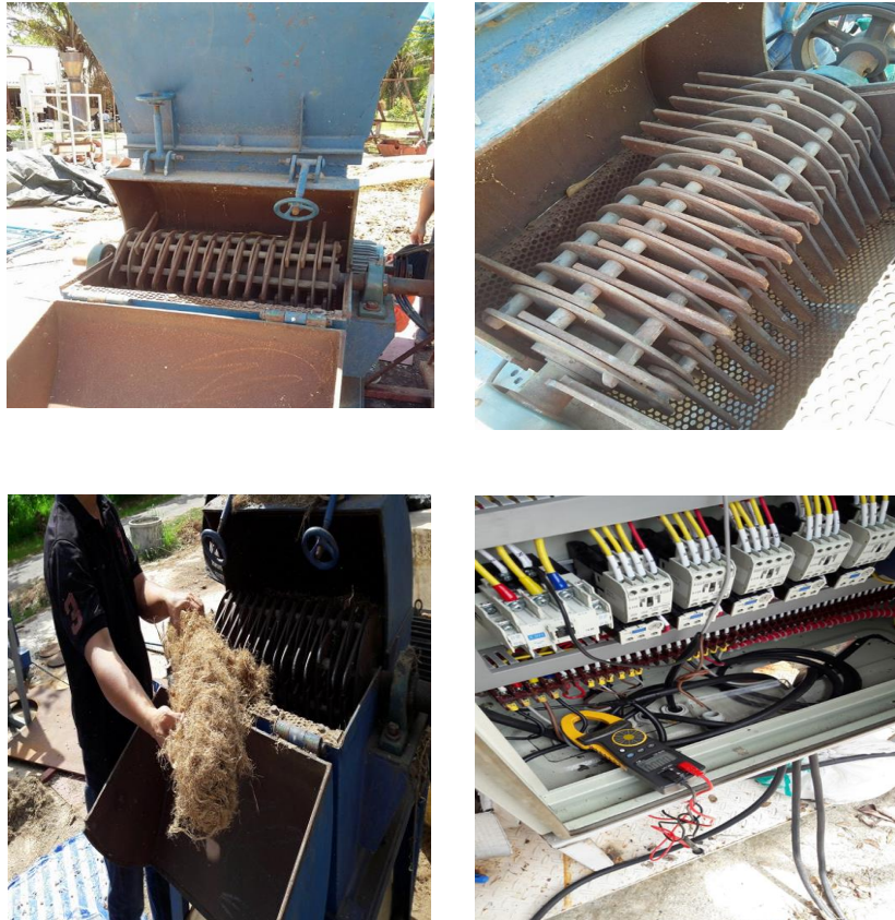
ภาพที่ 10 การทดสอบการบดย่อยด้วยเครื่องบดย่อยแบบใบมีดอิสระ
