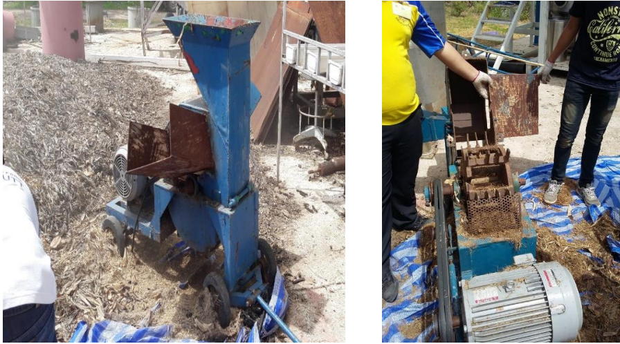
ภาพที่ 8 การทดสอบเครื่องสับย่อย (Hammer mill) แบบใบอยู่กับที่ของสถาบันวิจัยเกษตรวิศวกรรม
