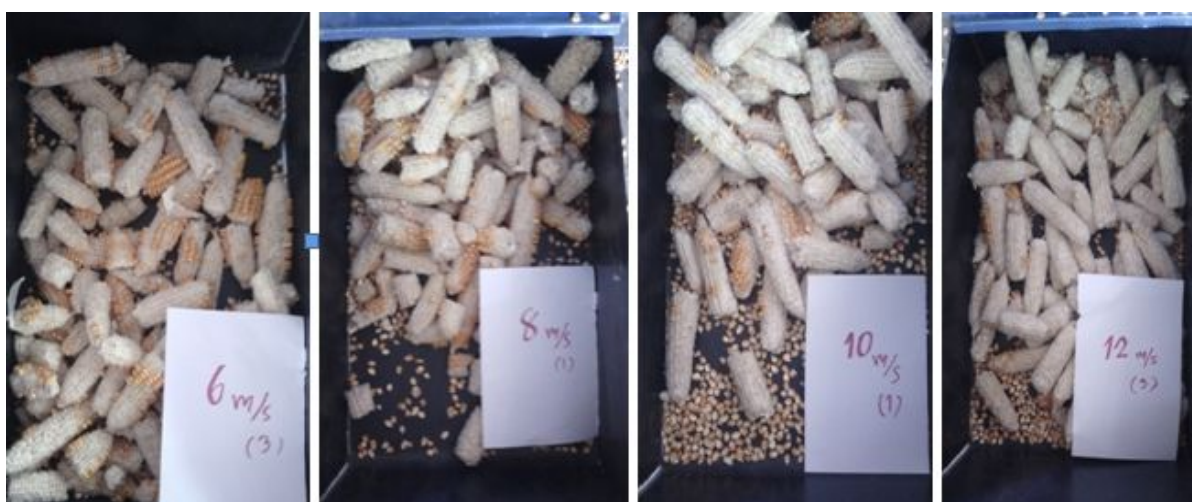
รูปที่ 4 ประสิทธิภาพการกะเทาะที่ระดับความเร็วเชิงเส้นต่างๆ
