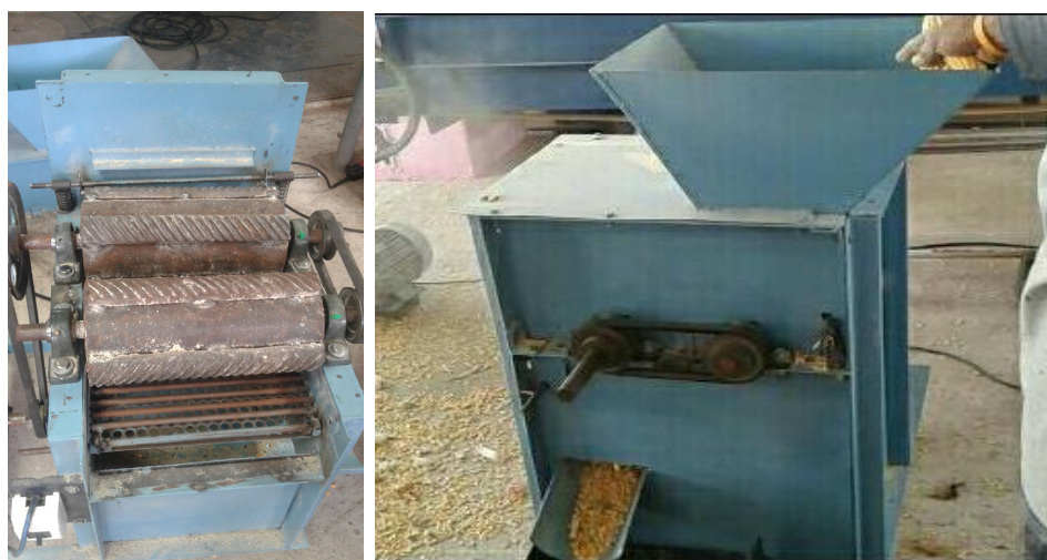
รูปที่ 2 ต้นแบบเครื่องกะเทาะข้าวโพดเลี้ยงสัตว์ แบบปอกเปลือกขนาดเล็ก 2 ลูก
