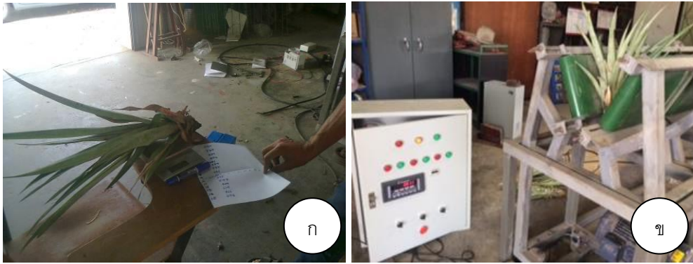
รูปที่ 17 การสอบเทียบเครื่องชั่งกับเครื่องชั่งขนาดเล็กที่พิกัดสูงสุด 2 กิโลกรัม ความละเอียด 0.1 กรัม ในสภาวะหยุดนิ่ง
