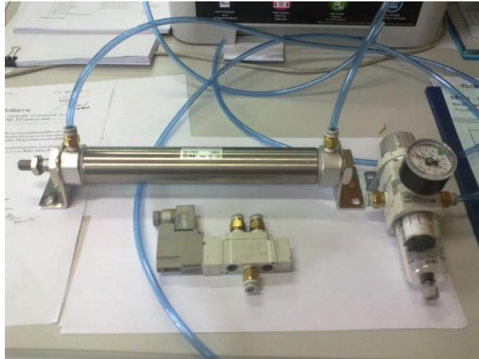
รูปที่ 11 อุปกรณ์นิวแมติกในการควบคุมระบบการคัดแยก
