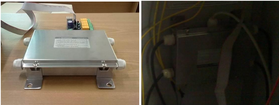
รูปที่ 9 กล่องรวมสัญญาณจาก Load cell ทั้งที่ 4 ตัวจากการชั่ง
