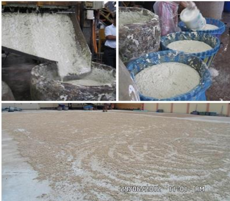
ภาพที่ 3 กากข้าวเหนียวเปียกผ่านออกจากเครื่องโม่บด กรองน้ำออกแล้วนำไปตากแห้ง
