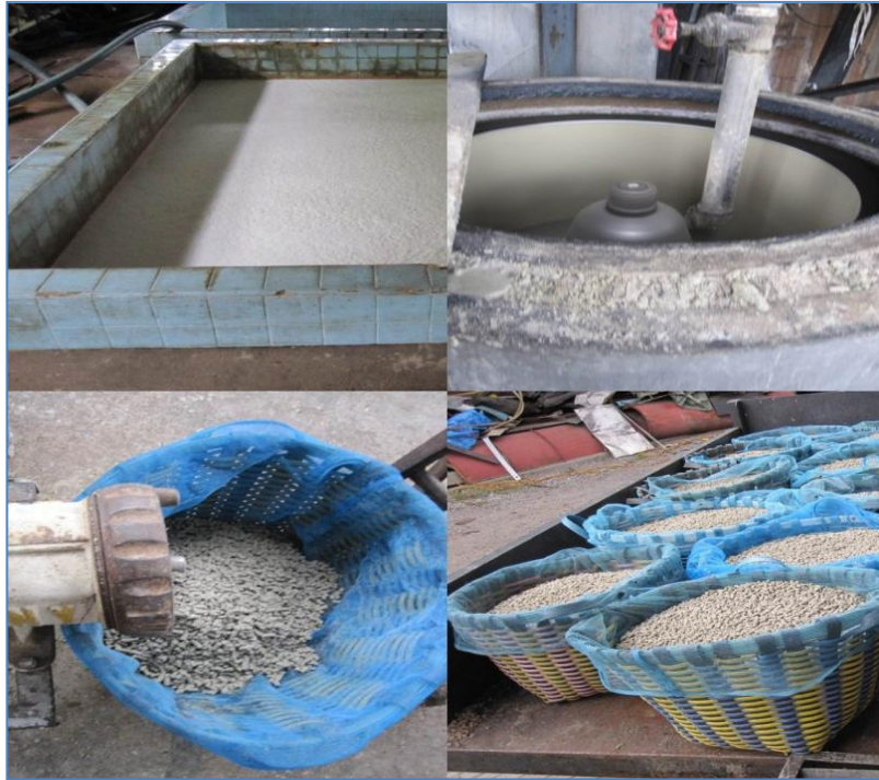
ภาพที่ 2 น้ำโปรตีนนำผ่านท่อความร้อนปล่อยลงในเครื่องกรองแรงเหวี่ยงแยกน้ำและโปรตีน นำโปรตีนสดผ่านลงในเครื่องบดทำให้เป็นผงเล็กๆ แล้วนำไปตากแห้ง
