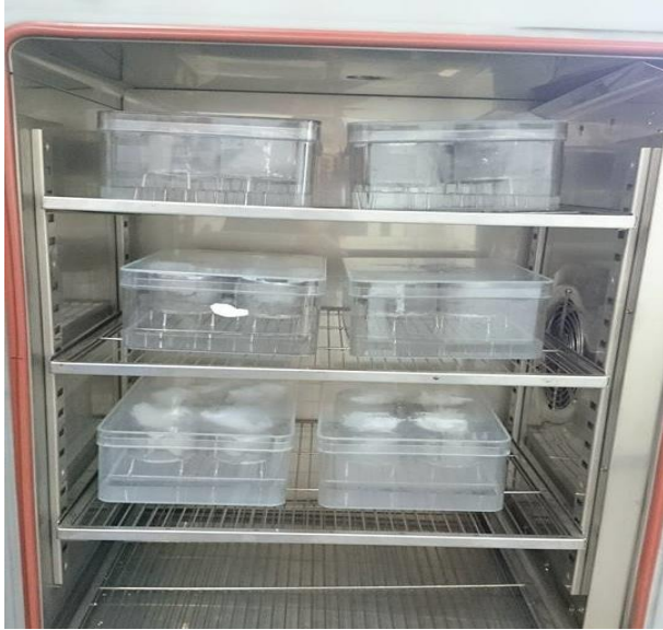
ภาพผนวกที่ 7 การทดสอบความแข็งแรงของเมล็ดพันธุ์ปอแก้วไทยโดยใช้วิธีเร่งอายุ (AA Test)
