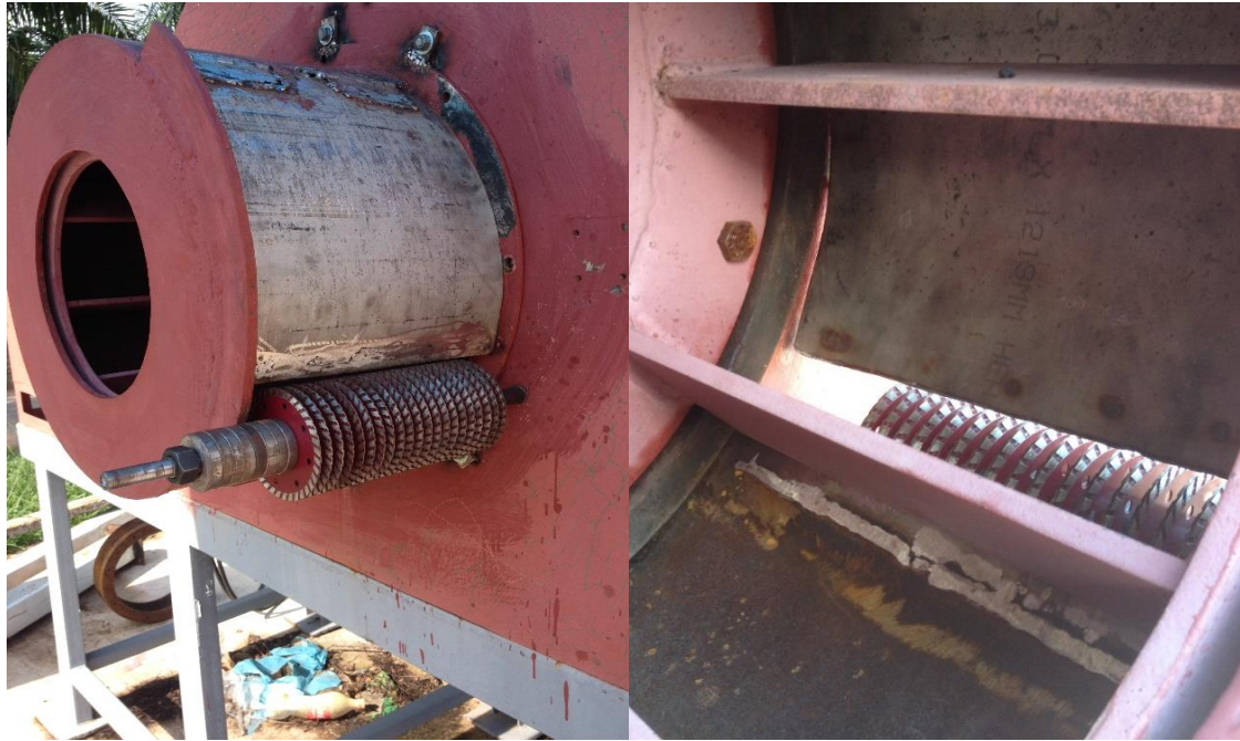
ภาพที่ 18 ชุดใบมีดสับมันสำปะหลังที่ทำให้เป็นเส้น
