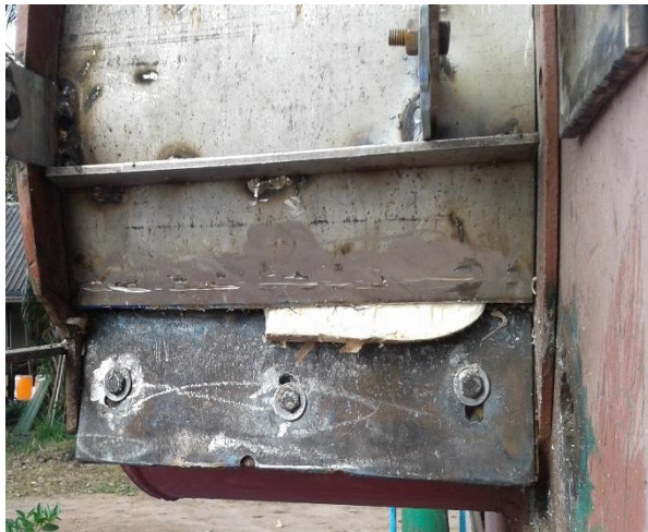
ภาพที่ 17 ใบมีดที่ทำการปรับปรุงและทดสอบสับมันเส้นเป็นแบบแผ่น
