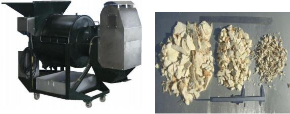
ภาพที่ 6 เครื่องสับมันเส้นที่มหาวิทยาลัยเทคโนโลยีภาคตะวันออกเฉียงเหนือและลักษณะชิ้นมันที่ผ่านการสับด้วยเครื่อง
