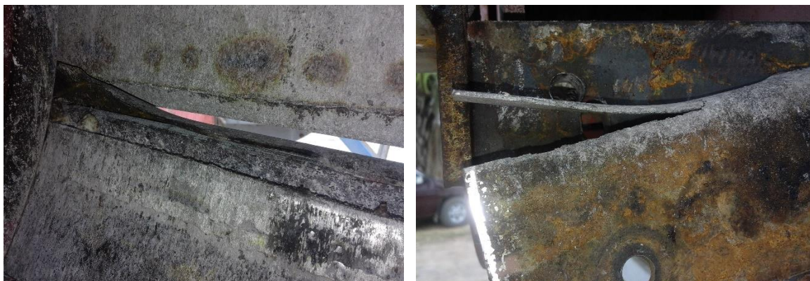
ภาพที่ 14 ลักษณะใบมีดที่เกิดจากการเสียหายจากเหง้ามันสำปะหลังที่ติดมากับหัวมัน
