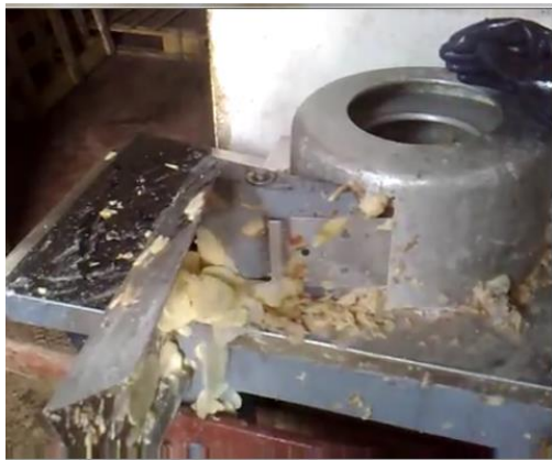
ภาพที่ 10 ลักษณะเครื่องสับมันฝรั่งในต่างประเทศ
