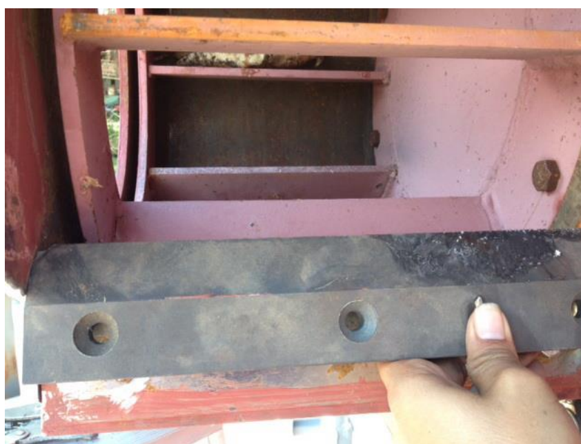
ภาพที่ 15 ลักษณะใบมีดสับมันสำปะหลังที่นำมาเปลี่ยนเพื่อการทดสอบ
