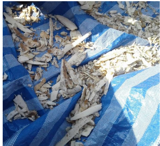
ภาพที่ 17 ใบมีดที่ทำการปรับปรุงและทดสอบสับมันเส้นเป็นแบบแผ่น
