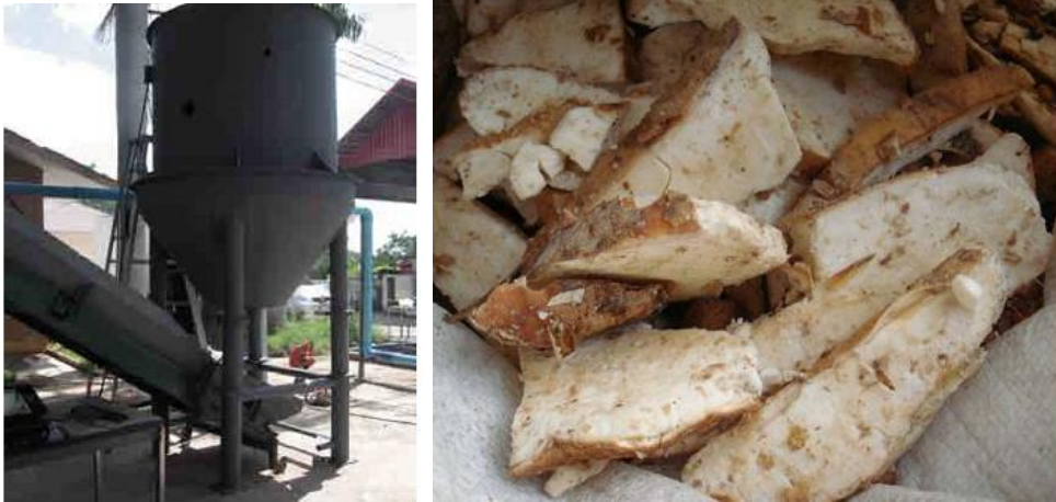
ภาพที่ 3 เครื่องสับมันสำปะหลังแนวตั้งและลักษณะขึ้นมันที่ผ่านการสับด้วยเครื่อง
