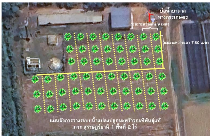
ภาพที่ 7 แผนผังการวางระบบน้ำแปลงปลูกมะพร้าวกะทิ
