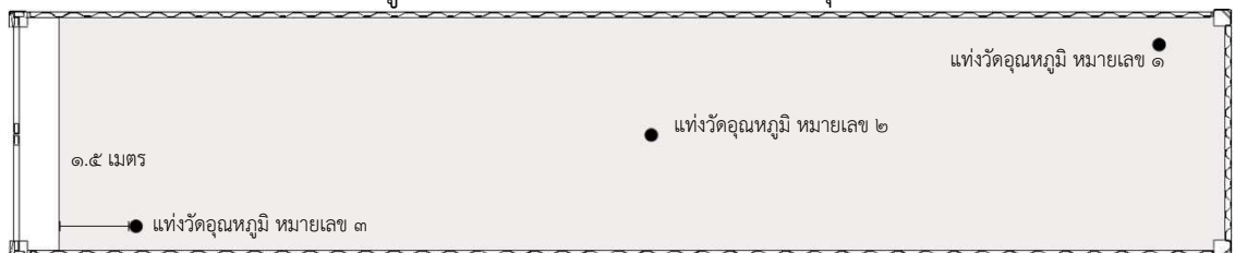
ภาพที่ ๑ ตำแหน่งการวางแท่งวัดอุณหภูมิผลไม้ภายในตู้ขนส่งสินค้าสำหรับการปฏิบัติหรือการบำบัดด้วยความเย็นระหว่างขนส่ง
