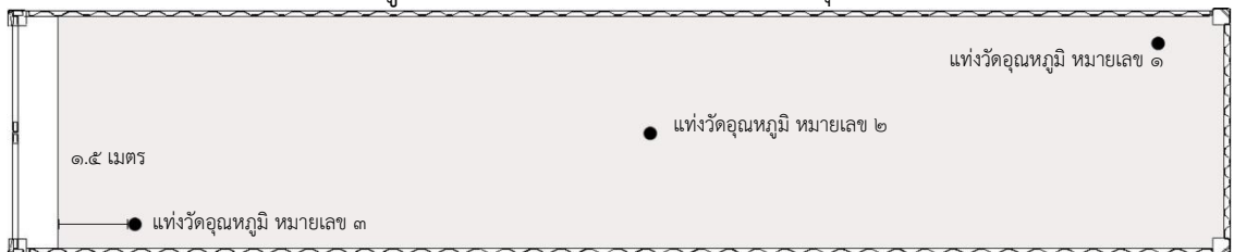
ภาพที่ ๑ ตำแหน่งการวางถังวัดอุณหภูมิผลไม้ภายในตู้ขนส่งสินค้าสำหรับการปฏิบัติหรือการบำบัดด้วยความเย็นระหว่างขนส่ง
