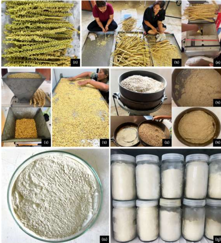
ภาพที่ 16 ขั้นตอนการผลิตละอองเกสรมะพร้าว น้ำหอม (ก) ลักษณะดอกตัวผู้แก่จัด (ข) ปลิดดอกตัวผู้ด้วยการใช้มือ (ค) การปลิดดอกตัวผู้ด้วยการใช้เครื่องปลิด (ง) บดดอกตัวผู้ด้วยเครื่องบด (จ) ตากดอกตัวผู้ (ฉ) ร่อนดอกตัวผู้ด้วยเครื่องกระแทกเพื่อให้ละอองเกสรหลุดออกมา (ช) ร่อนละอองเกสรด้วยตะแกรงหยาบ (ฌ) ร่อนละอองเกสรด้วยตะแกรงละเอียด (ฒ) ละอองเกสร (ณ) บรรจุละอองเกสรใส่ขวดแก้ว
