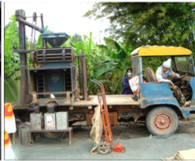
สีผลกาแฟแห้งด้วยเครื่องสี
