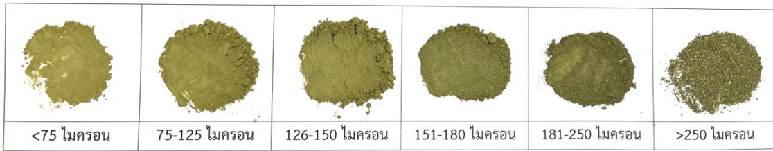
ภาพที่ 7 ขนาดของผงชาที่มีตะกอนหลังจากคัดแยกด้วยเครื่องเขย่าตะแกรงร้อน
