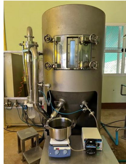
ภาพที่ 7.26 เปิดเครื่องฟีด เพื่อนำ น้ำสกัดปัญจชันท์ไหลเข้าเครื่องอบ แห้งแบบพ่นฝอย
