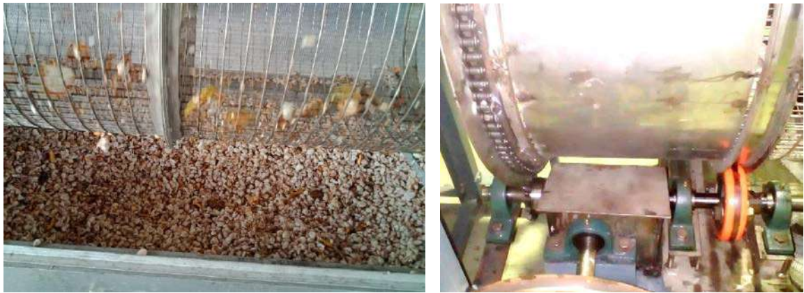
ภาพที่ 7.3 รูปแบบการทำงานและการส่งกำลังของชุดคัดแยกเมล็ดโกโก้
