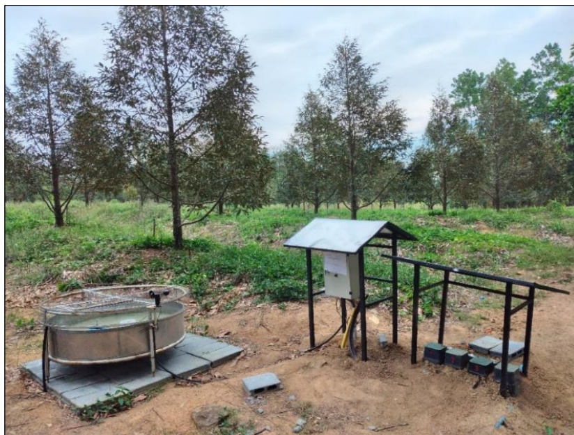
ภาพที่ 2.1 ทดสอบระบบควบคุมอัตโนมัติการให้น้ำทุเรียนโดยใช้ค่าจากสภาพวัดระเหย (Epan) ในแปลงปลูก
