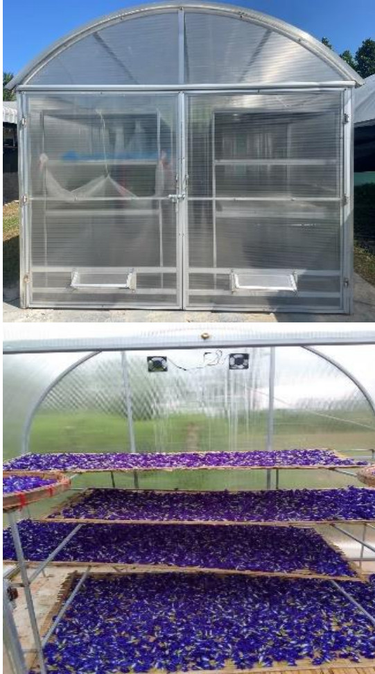
ภาพที่ 9 อบอัญชันในโรงอบพลังงานแสงอาทิตย์
