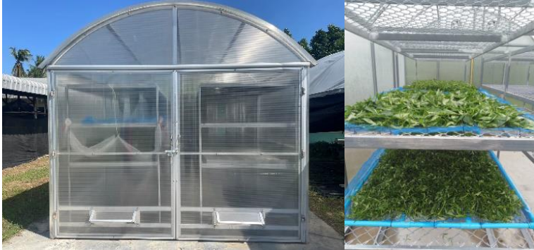
ภาพที่ 11 ออบฟ้าทะลายโจรในโรงอบพลังงานแสงอาทิตย์
