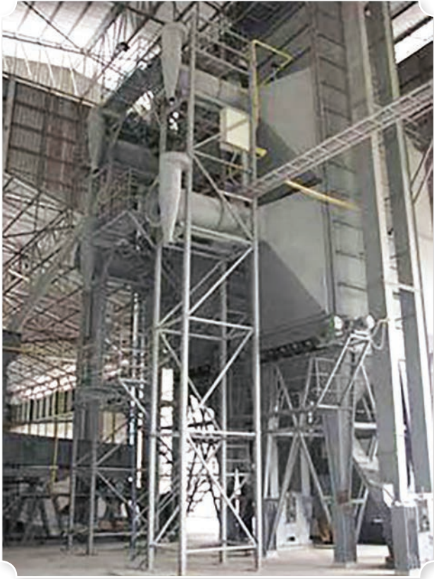
ชุดดักฝุ่นสำหรับพัฒนาระบบแรงเหวี่ยงหนีศูนย์กลาง
