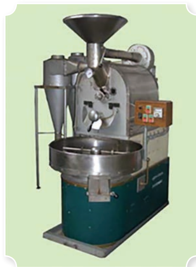
เครื่องคั่วขนาด 12 กิโลกรัมต่อครั้ง
