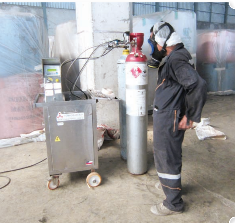
สารรมเวเปอร์ฟอส และเครื่อง Horn Diluphos system
