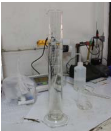
(ค) ผสมสารละลาย IBA ด้วยน้ำกลั่น 500 มิลลิลิตร ได้สารละลาย IBA 6,000 ppm
