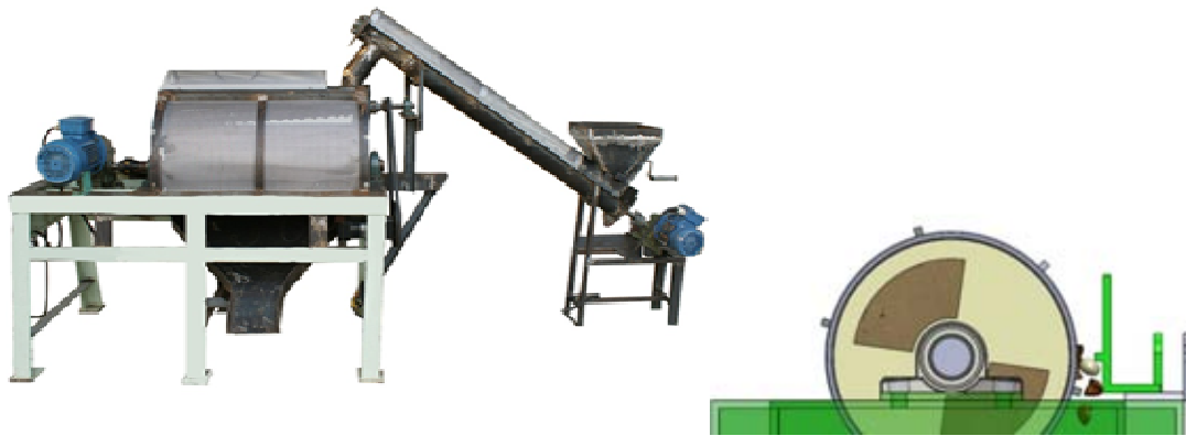
ภาพที่ 52 เครื่องกะเทาะเมล็ดมะคาเดเมียระดับอุตสาหกรรม (ที่มา: สนอง และคณะ, 2553ก)
