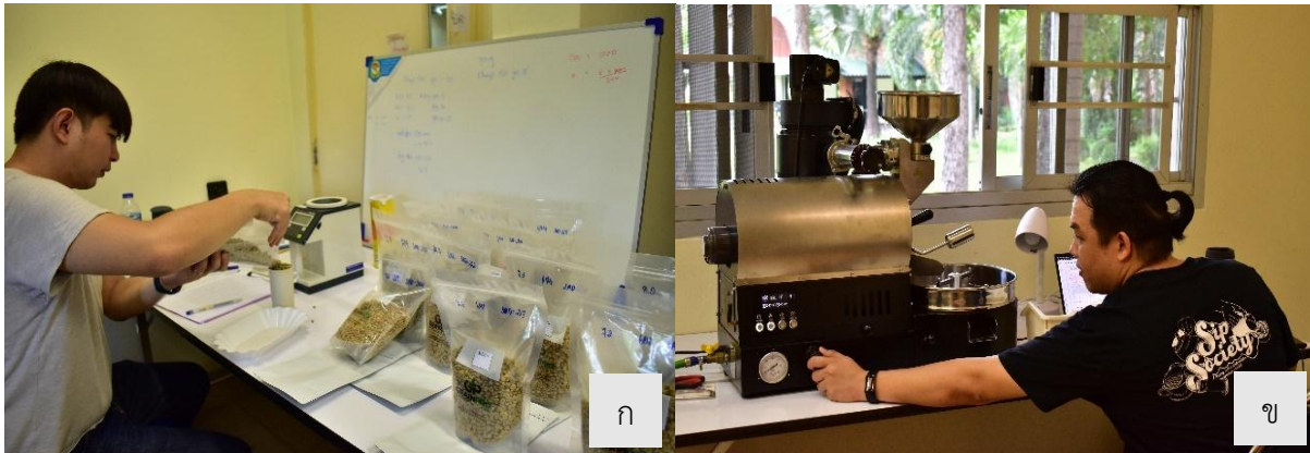
ภาพที่ ๖ การวัดความหนาแน่นเมล็ดกาแฟก่อนคั่ว (ก) การเตรียมเครื่องคั่ว (ข)
