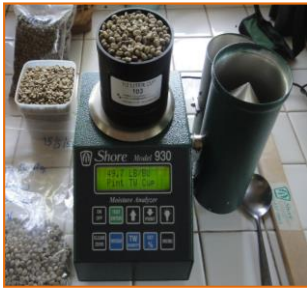
เครื่องวัดความชื้นยี่ห้อ Shore Model 930™ Portable Moisture
