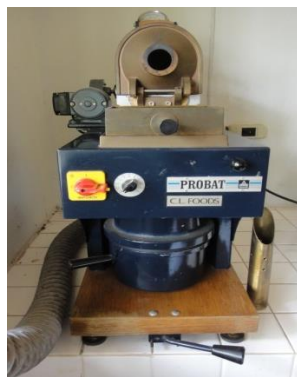
เครื่องคั่วยี่ห้อ PROBAT รุ่น PRE-1 ELECTRIC ROASTER (พลังงานไฟฟ้า)
