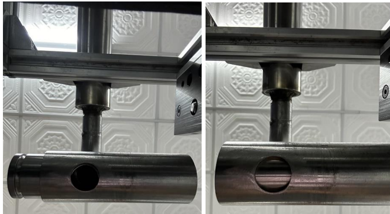
ภาพที่5 ชุดลิ้นเปิด-ปิดหยอดขึ้นรูปน้ำตาลมะพร้าว (หลังปรับปรุง)
