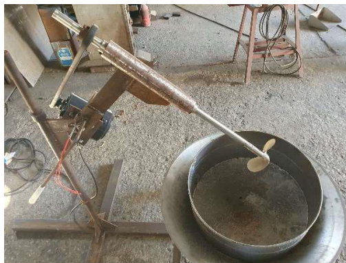
ภาพที่1 ต้นแบบชุดทดสอบระดับปัจจัยสำหรับกระบวนการกวนน้ำตาลมะพร้าว
