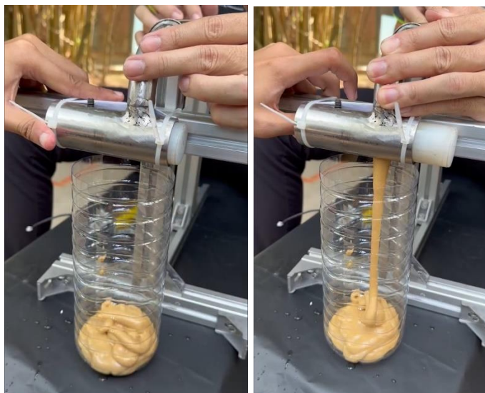
ภาพที่6 การทำงานของชุดลิ้นเปิด-ปิดหยอดขึ้นรูปน้ำตาลมะพร้าว (หลังปรับปรุง)
