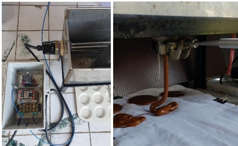
ภาพที่3 ต้นแบบชุดทดสอบระดับปัจจัยสำหรับกระบวนการหยอดขึ้นรูปน้ำตาลมะพร้าว (ก่อนปรับปรุง)
