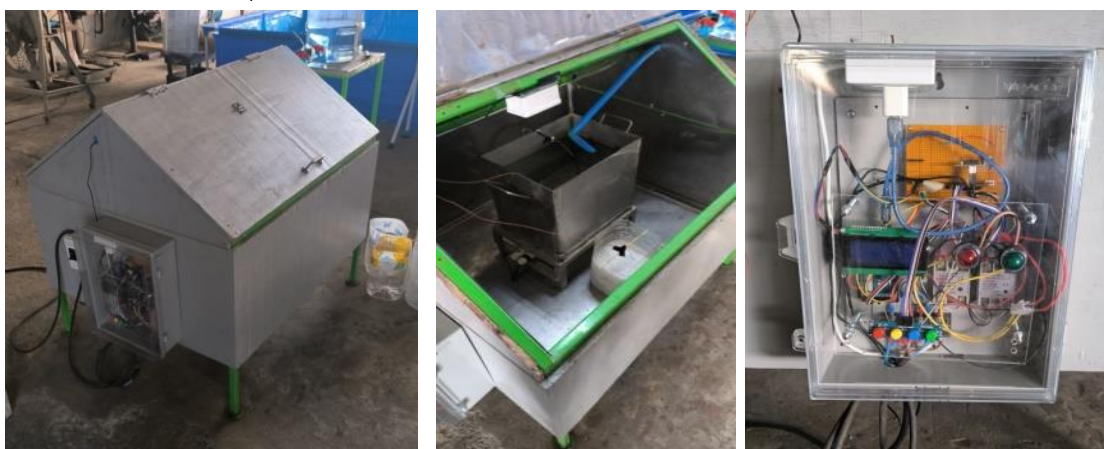
ภาพที่ 1 ชุดทดสอบบ่มอุณหภูมิ
