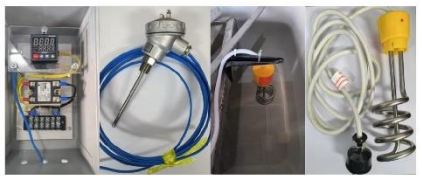
ภาพที่ 1 แสดงส่วนประกอบเครื่องต้นแบบ ระบบควบคุม หัววัดอุณหภูมิและฮิสเตอร์
