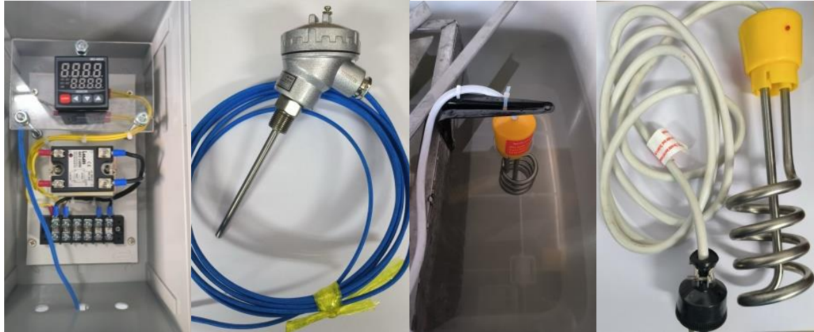
ภาพที่ 1 แสดงส่วนประกอบเครื่องต้นแบบ ระบบควบคุม หัววัดอุณหภูมิและฮีตเตอร์
