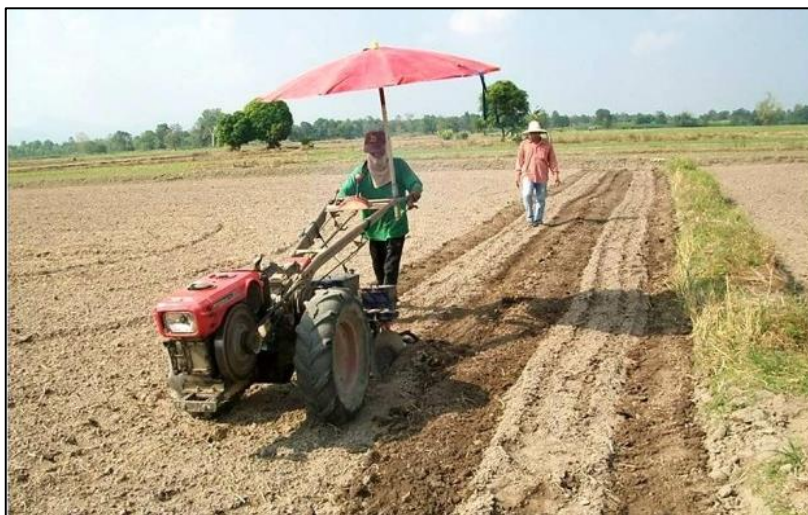
ภาพ 4 การปลูกบนพื้นราบ ใช้เครื่องปลูกติดท้ายรถไถเดินตาม
