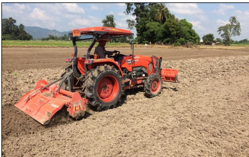
ภาพ 2 พรวนดินให้ละเอียดด้วยพาล 7 หรือโรตารี 1-2 ครั้ง
