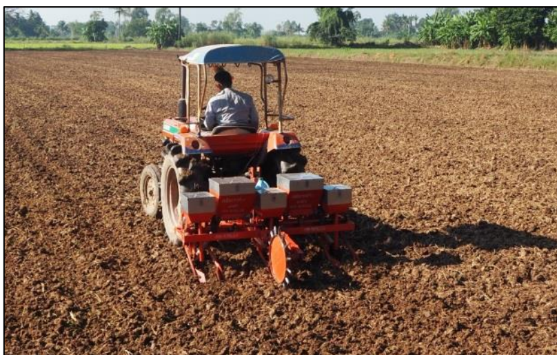
ภาพ 5 การปลูกบนพื้นราบ ใช้เครื่องปลูกติดท้ายรถแทรกเตอร์เล็ก
