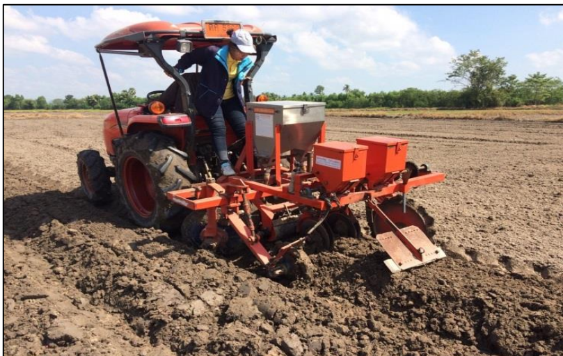
ภาพ 6 การปลูกแบบยกร่อง โดยเครื่องปลูกพร้อมยกร่องและใส่ปุ๋ย
