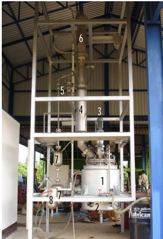
ภาพที่ 2 ชุดเครื่องกลั่นบริสุทธิ์กลีเซอรินด้วยระบบสุญญากาศขนาด 100 ลิตรต่อแบทช์
