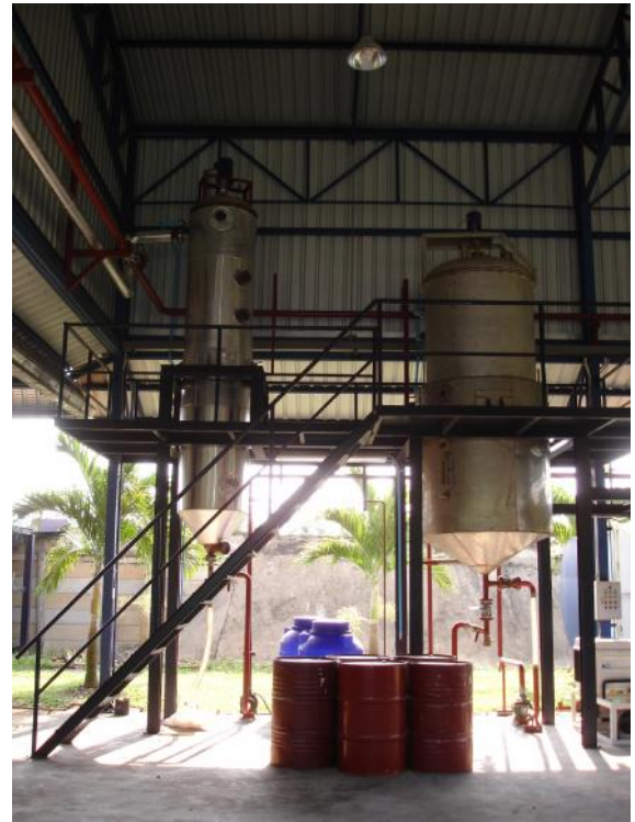
ภาพผนวกที่ 1 ต้นแบบระบบผลิตไบโอดีเซลระดับชุมชนแบบครบวงจร โรงงานสกัดน้ำมันปาล์มดิบ (a) หม้อน้ำโรงสกัดน้ำมันปาล์มดิบ (b) ต้นแบบชุดผลิตไบโอดีเซล (c) และต้นแบบชุดกลั่นบริสุทธิ์กทีซีเออริน (c)
