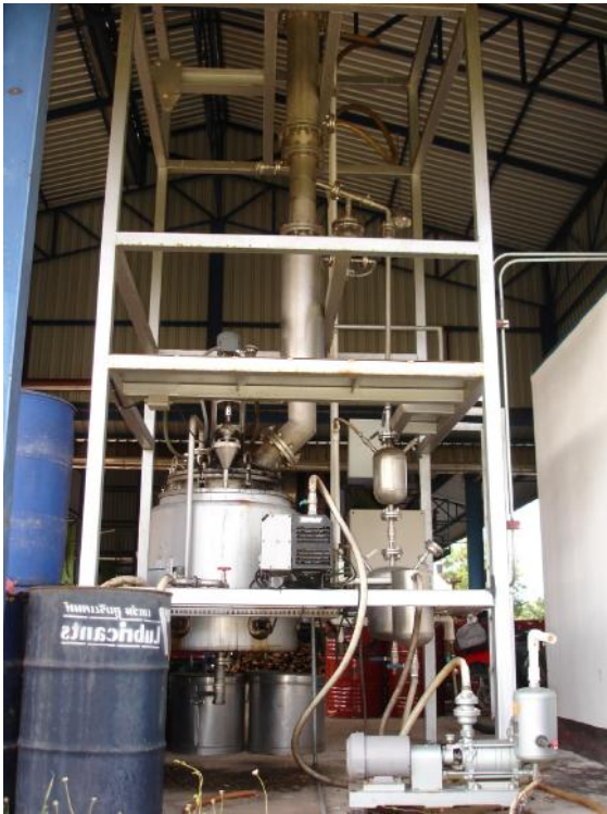
ภาพผนวกที่ 1 ต้นแบบระบบผลิตไบโอดีเซลระดับชุมชนแบบครบวงจร โรงงานสกัดน้ำมันปาล์มดิบ (a) หม้อน้ำโรงสกัดน้ำมันปาล์มดิบ (b) ต้นแบบชุดผลิตไบโอดีเซล (c) และต้นแบบชุดกลั่นบริสุทธิ์กทีซีเออริน (c)
