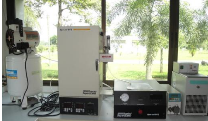
ภาพที่ 2 เครื่องสกัดสารเทคนิค Super-critical Fluid Extraction (SFE) รุ่น Spe-ed SFE ของ Applied Separations
