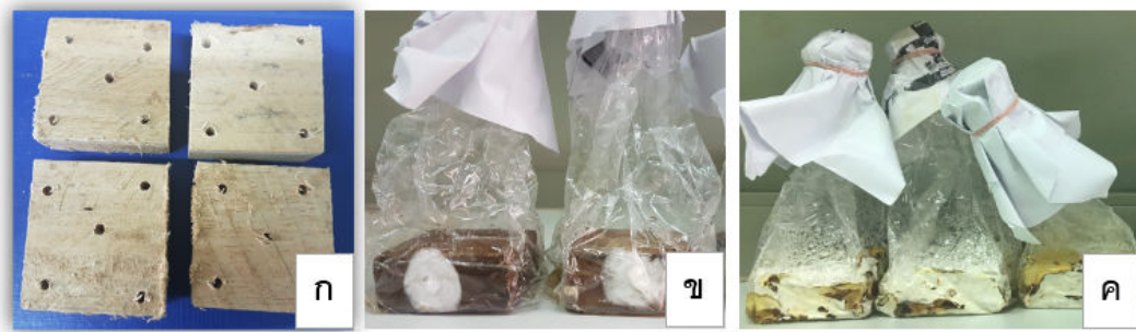
ภาพที่ 2.3(2) ชิ้นไม้ยางพาราสำหรับเลี้ยงเชื้อรา Ganoderma sp. (ก) การเจริญเติบโตบนชิ้นไม้ยางพาราที่เททับด้วยอาหาร PDA (ข) การเจริญของเส้นใย Ganoderma บนชิ้นไม้ยางพาราที่เททับด้วยอาหาร PDA (ค)
