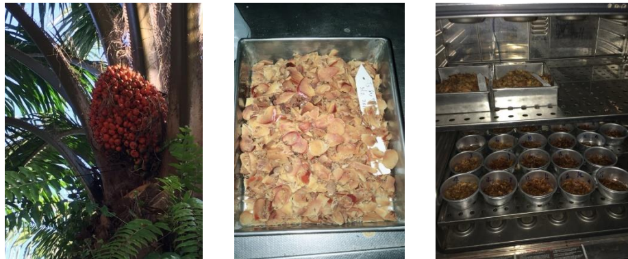
ภาพที่ 3.2-1 ทะลายตัวอย่างและเปลือกผลปาล์มในตู้อบความร้อนเพื่อเตรียมสกัดน้ำมัน
