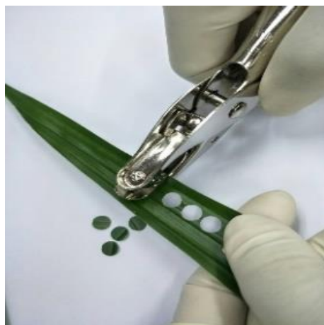
ภาพที่ 2 ชิ้นส่วนของใบปาล์มน้ำมันขนาดเส้นผ่านศูนย์กลาง 6 มิลลิเมตร ที่ใช้ในการทดสอบการรวมตัวอย่างเพื่อสกัดดีเอ็นเอรวม
