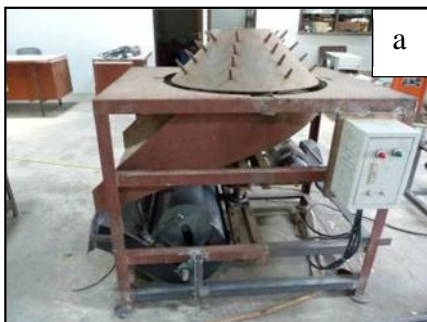
ภาพที่ 6 ชุดควบคุมการทำงานมอเตอร์ไฟฟ้า และการหมุนสลับทิศทางของจานหมุน (a) และชุดถ่ายทอดกำลังโดยพูลเลย์และสายพานจากมอเตอร์ไฟฟ้าขับเคลื่อนจานหมุน พัดลม และตะแกรงโยก (b)
