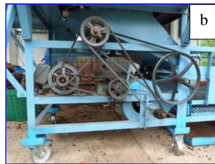
ภาพที่ 6 ชุดควบคุมการทำงานมอเตอร์ไฟฟ้า และการหมุนสลับทิศทางของจานหมุน (a) และชุดถ่ายทอดกำลังโดยพูลเลย์และสายพานจากมอเตอร์ไฟฟ้าขับเคลื่อนจานหมุน พัดลม และตะแกรงโยก (b)
