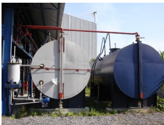
6 รเชื่อมต่อระบบท่อและปั๊มของชุดผลิตไบโอดีเซล
