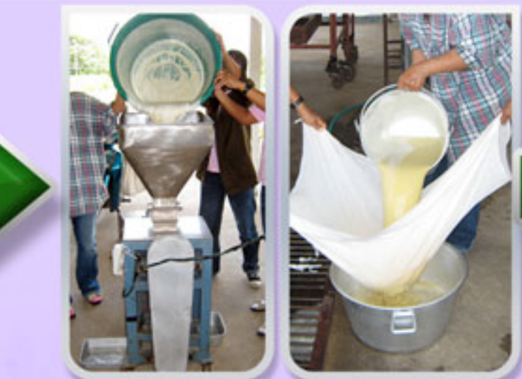
นำน้ำแป้งและกากกั่วเข้าเครื่องกรอง แยกกากจะได้น้ำโปรตีนและแป้ง แล้วกรองด้วยผ้าขาวบาง
