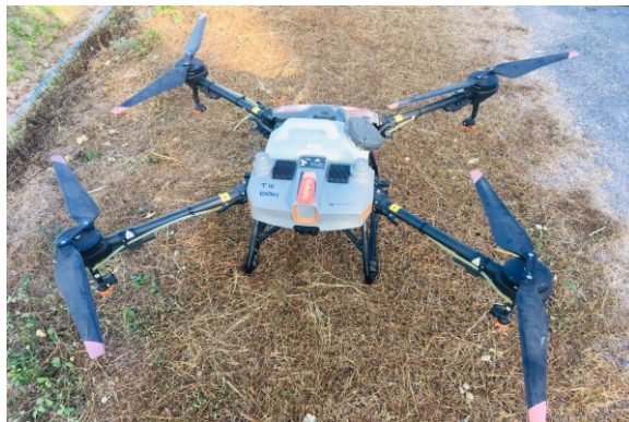
รูปที่ 12 โดรนพ่นสารเคมีป้องกันกำจัดแมลงศัตรูพืช ขนาด 10 ลิตร
