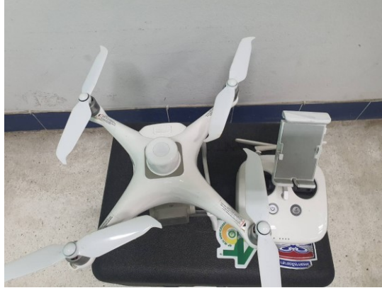
รูปที่ 15 โดรนติดกล้องถ่ายภาพแบบมัลติสเปกตรัม
