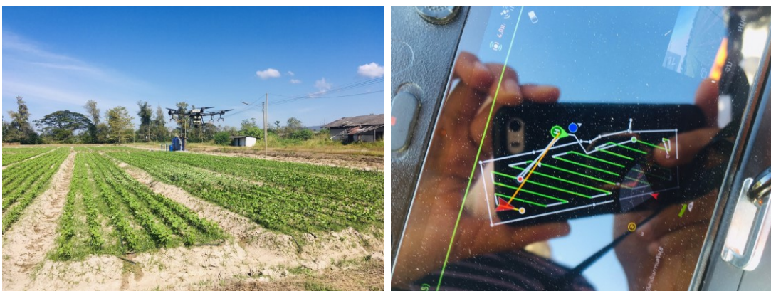
รูปที่ 13 การใช้โดรนฉีดพ่นสารเคมีป้องกันกำจัดแมลงศัตรูพืช
