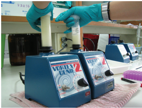
ภาพที่ 3 สกัดสารตัวอย่างด้วยเครื่อง vortex
