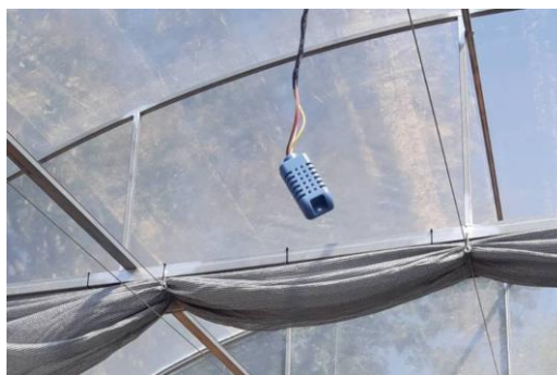
รูป เซนเซอร์วัดอุณหภูมิอากาศในโรงเรือน ซึ่งส่งข้อมูลให้สมองกลฝังตัวทุก 3 นาที
