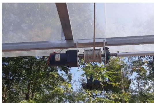
รูป มอเตอร์ขับเคลื่อนพรางแสง ทำงานอัตโนมัติเมื่ออุณหภูมิสูงกว่า 30 องศาเซลเซียส และตัดอัตโนมัติเมื่อตาข่ายพรางแสงเลื่อนสุดถึงเซนเซอร์จับโลหะ
