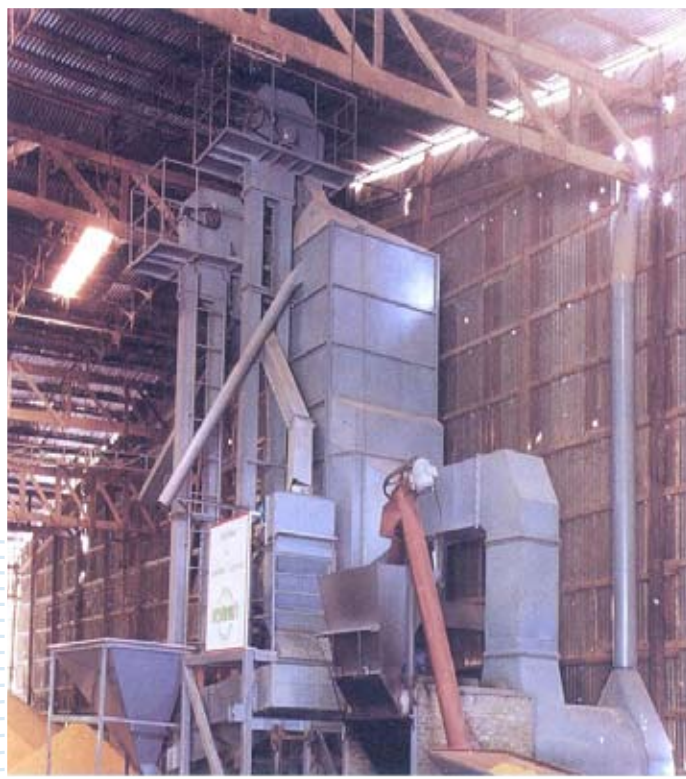
รูปที่ 2 เครื่องอบลดความชื้นเมล็ดพืชแบบกองเกษตรวิศวกรรมที่พัฒนาขึ้นขนาด 30 ตันต่อวัน
