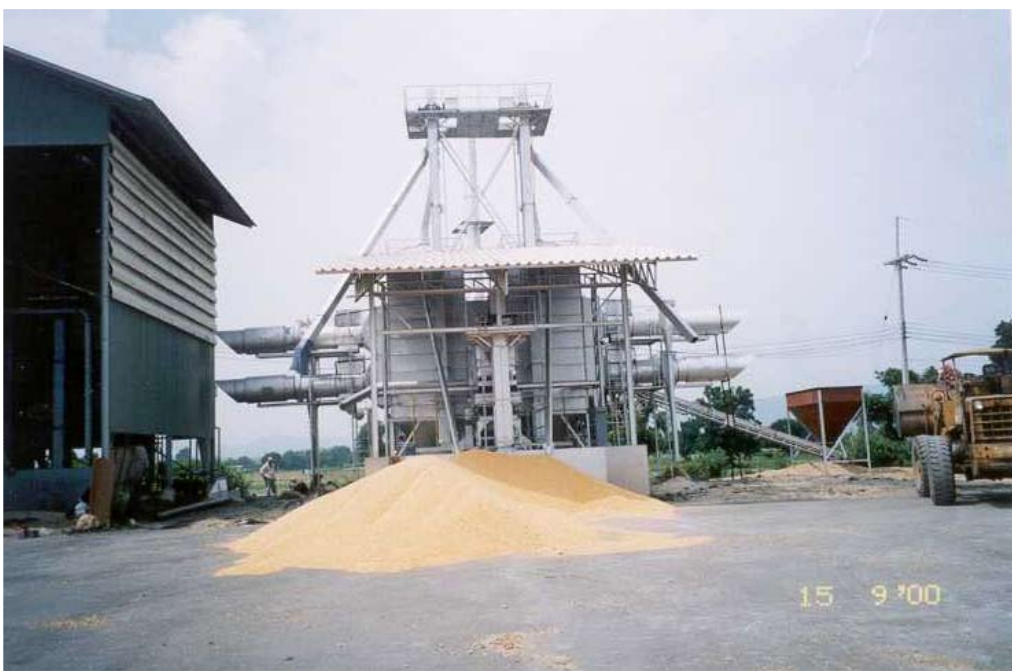
รูปที่ 5 เครื่องอบลดความชื้นข้าวโพดแบบของกองเกษตรวิศวกรรมขนาด 100 ตันต่อวัน
