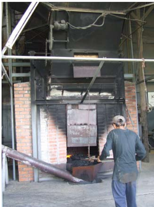
รูปที่ 3 เตาเผาแลกเปลี่ยนแบบตะกรับพร้อมชุดแลกเปลี่ยนความร้อน
