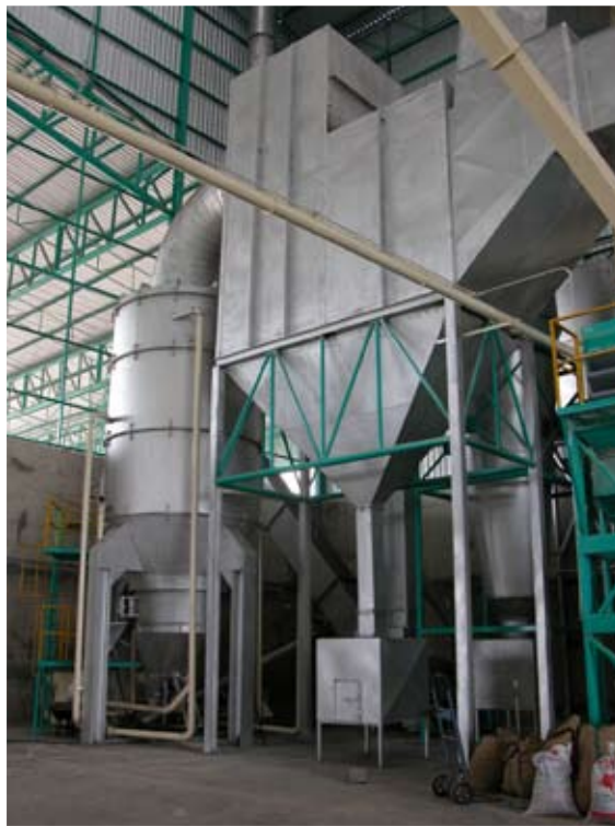
รูปที่ 7 เตาเชื้อเพลิงชีวมวลแบบไซโคลนที่เอกชนขอแบบนำไปผลิตจำหน่าย
