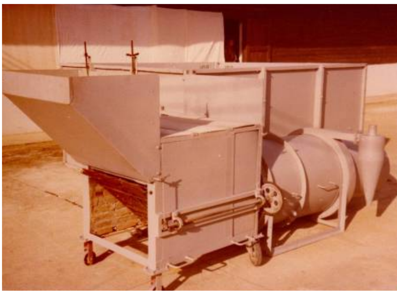
รูปที่ 1 เครื่องอบลดความชื้นข้าวเปลือกแบบกระบอกขนาดบรรจุ 2 ตัน
