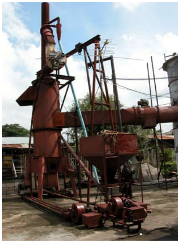
รูปที่ 6 ต้นแบบเตาเผาแกลบแบบไซโคลน
