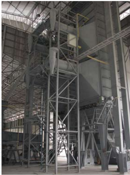
รูปที่ 4 ชุดดักฝุ่นสำหรับพัฒลมแบบแรงเหวี่ยงหนีศูนย์กลาง
