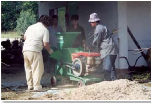
รูปที่ 12. ลักษณะการทำงานเครื่องหันบดซากวัชพืช ทำให้เกิดฝุ่นละอองฟุ้งกระจาย
