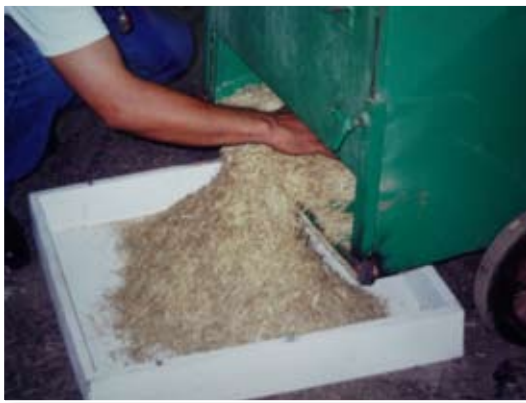
รูปที่ 13. ลักษณะการทำงานเครื่องตีบดซากวัชพืช ที่มีไซโคลน เก็บฝุ่น แบบถุงผ้า
