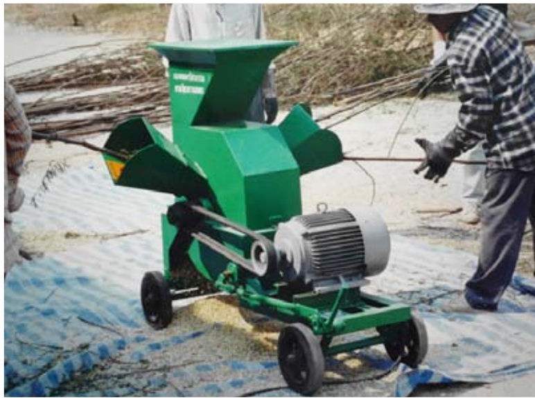
รูปที่ 10. ลักษณะการทำงานของเครื่องหั่นบดซากต้นไมยราบยักษ์
