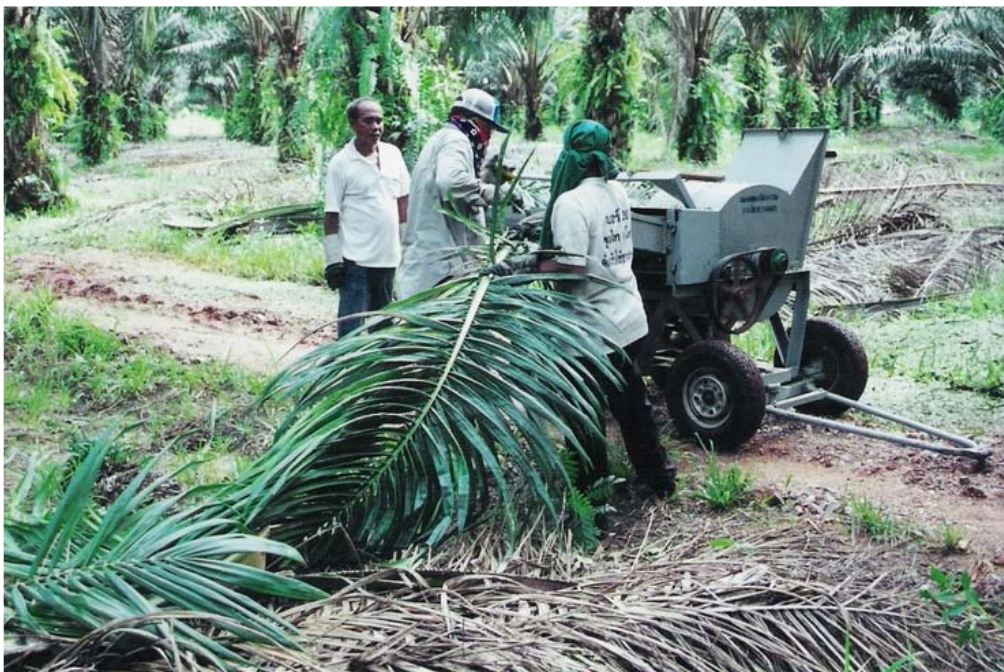
รูปที่ 7. ลักษณะการทำงานเครื่องหั่นย่อยทางปาล์ม
