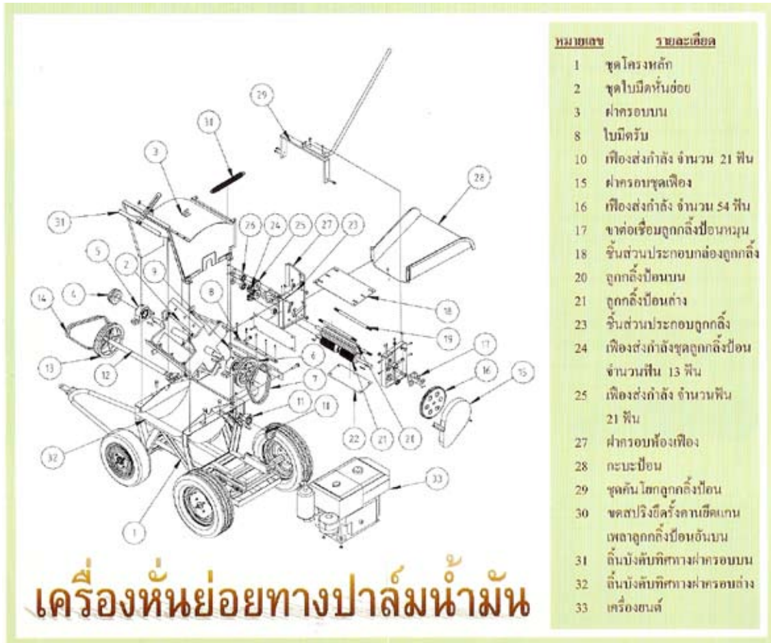
รูปที่ 9. ระบบกลไกและชิ้นส่วนสำคัญเครื่องหั่นย่อยทางปาล์มน้ำมัน
