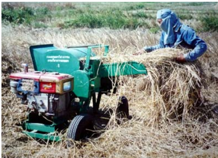
รูปที่ 3. ลักษณะการทำงานของเครื่องหั่นฟาง
