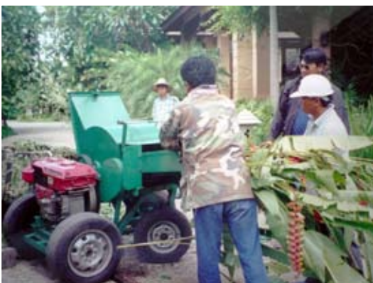
รูปที่ 8. เครื่องหั่นย่อยทางปาล์ม สามารถใช้หั่นย่อยทางใบของพืชตระกูลปาล์มอื่นๆ เช่น สะระ มะพร้าว เป็นต้น และทลายปาล์ม
