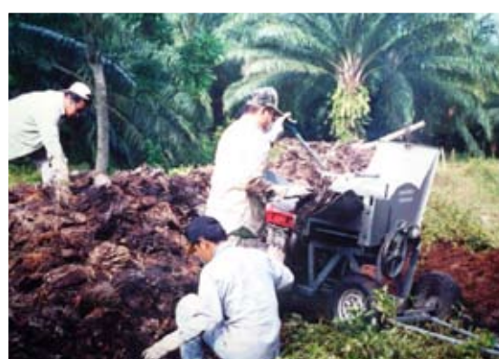
รูปที่ 8. เครื่องหั่นย่อยทางปาล์ม สามารถใช้หั่นย่อยทางใบของพืชตระกูลปาล์มอื่นๆ เช่น สะระ มะพร้าว เป็นต้น และทลายปาล์ม
