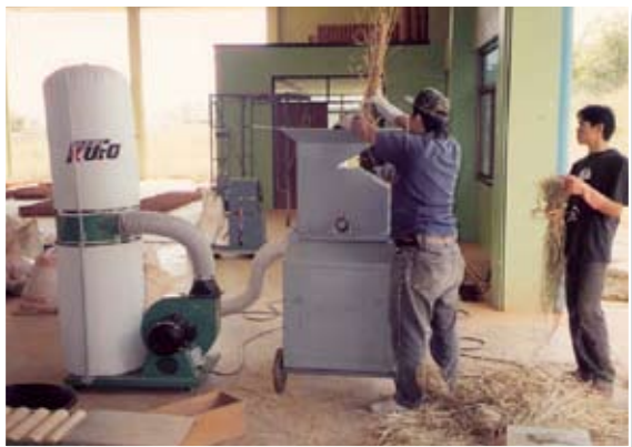
รูปที่ 13. ลักษณะการทำงานเครื่องตีบดซากวัชพืช ที่มีไซโคลน เก็บฝุ่น แบบถุงผ้า
