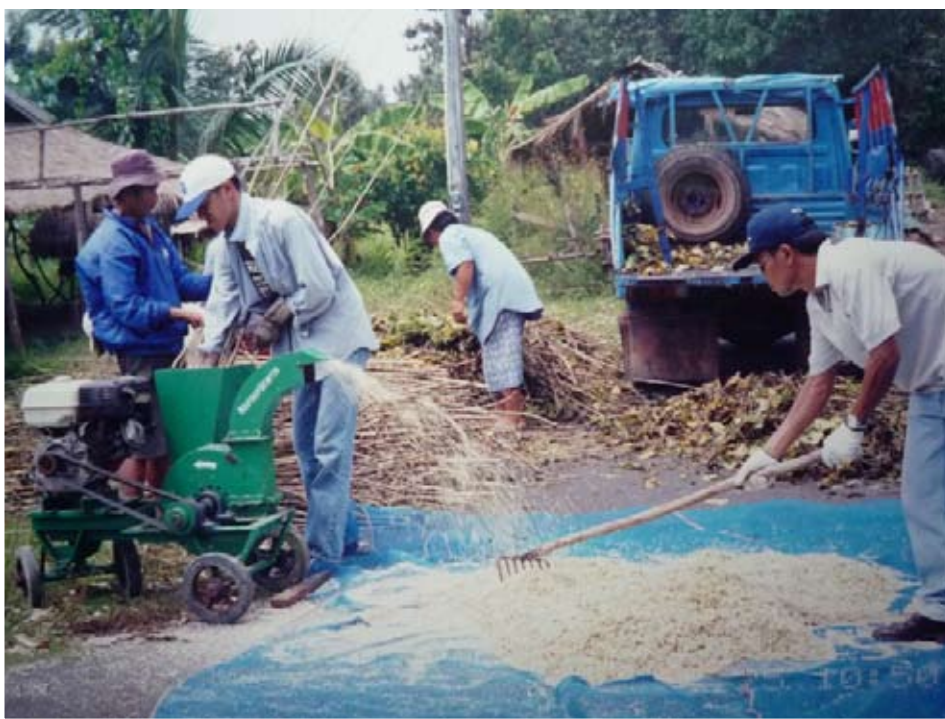
รูปที่ 5. ลักษณะการทำงานของเครื่องหั่นย่อยซากพืชเส้นใย
