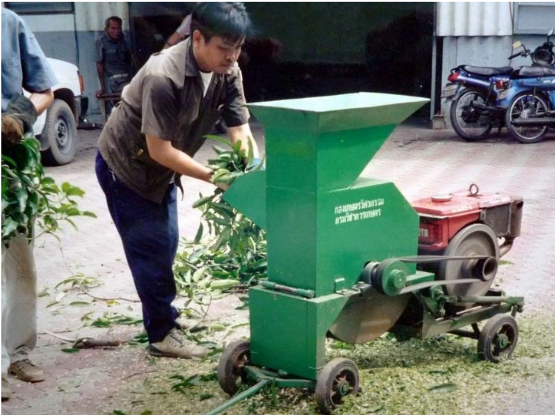
รูปที่ 1. ลักษณะการทำงานของเครื่องหั่นย่อยกิ่งไม้ผล
