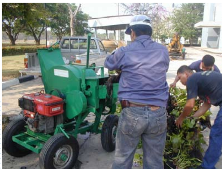
รูปที่ 4. เครื่องหั่นฟางใช้หั่นผักตบชวา
