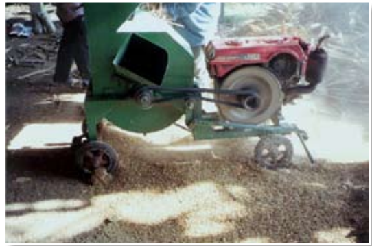
รูปที่ 12. ลักษณะการทำงานเครื่องหันบดซากวัชพืช ทำให้เกิดฝุ่นละอองฟุ้งกระจาย
