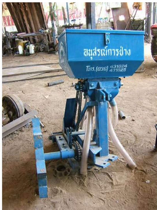
ภาพที่ 17 เครื่องยึดติดเป็นชิ้นเดียว ติดตั้งยาก
