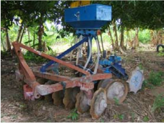
ภาพที่ 35 ใช้กับรถไถขนาด 80 แรงม้า โค้งพาล 14 จาน ยาว 180 เซนติเมตร
