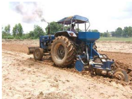
ภาพที่ 30 ใช้กับรถไถขนาด 80 แรงม้า โค้งพาล 7 จาน ยาว 180 เซนติเมตร
