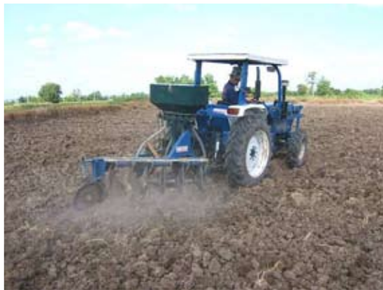
ภาพที่ 33 ใช้กับรถไถขนาด 45 แรงม้า โค้งพาล 6 จาน ยาว 147 เซนติเมตร
