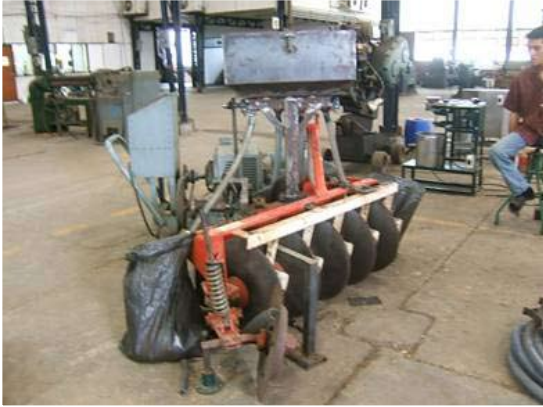
ภาพที่ 27 ใช้กับรถไถขนาด 28 แรงม้า ไครงพาล 5 จาน ยาว 125 เซนติเมตร
