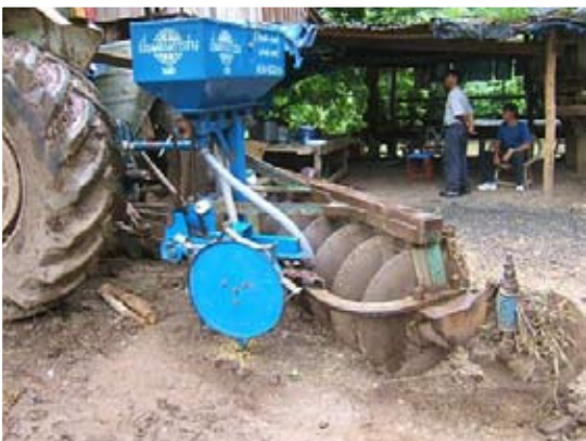
ภาพที่ 34 ใช้กับรถไถขนาด 60 แรงม้า โค้งพาลเหลี่ยม 7 จาน ยาว 180 เซนติเมตร
