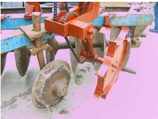
ภาพที่ 37 ใช้กับรถไถขนาด 60 แรงม้า โค้งพาลเหลี่ยม 7 จาน ยาว 210 เซนติเมตร
