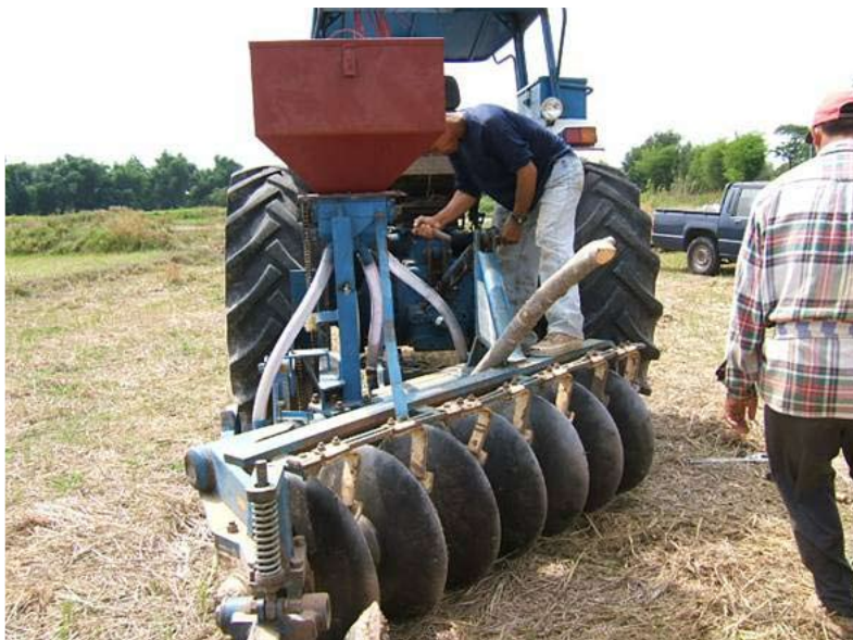
ภาพที่ 16 ตำแหน่งเครื่องถ่วงท้ายผลมากเกินไป
