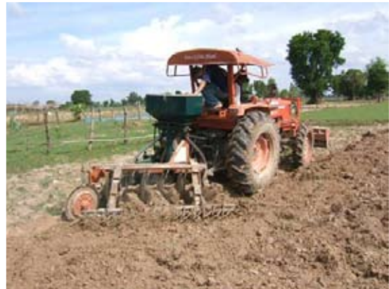
ภาพที่ 29 ใช้กับรถไถขนาด 50 แรงม้า โค้งพาล 6 จาน ยาว 150 เซนติเมตร
