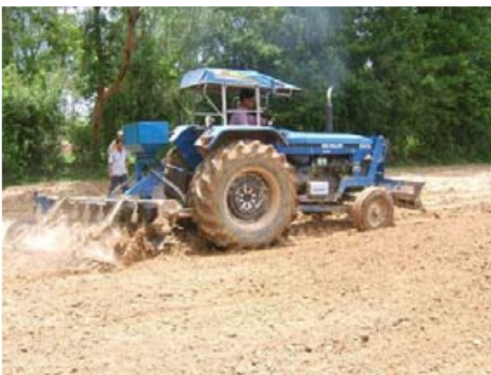
ภาพที่ 30 ใช้กับรถไถขนาด 80 แรงม้า โค้งพาล 7 จาน ยาว 180 เซนติเมตร
