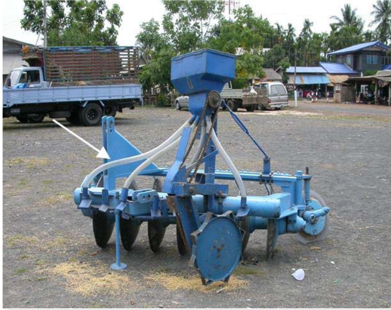
ภาพที่ 15 สายยางทอนอนมากเกินไป
