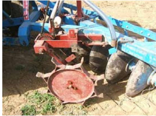
ภาพที่ 36 ใช้กับรถไถขนาด 60 แรงม้า โค้งพาลเหลี่ยม 7 จาน ยาว 210 เซนติเมตร
