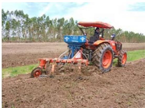
ภาพที่ 31 ใช้กับรถไถขนาด 70 แรงม้า โค้งพาล 7 จาน ยาว 180 เซนติเมตร
