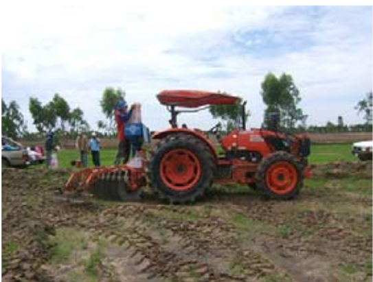
ภาพที่ 31 ใช้กับรถไถขนาด 70 แรงม้า โค้งพาล 7 จาน ยาว 180 เซนติเมตร
