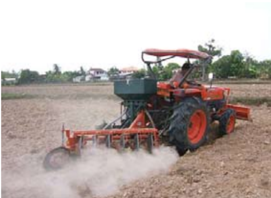
ภาพที่ 28 ใช้กับรถไถขนาด 45 แรงม้า ไครงพาล 6 จาน ยาว 147 เซนติเมตร
