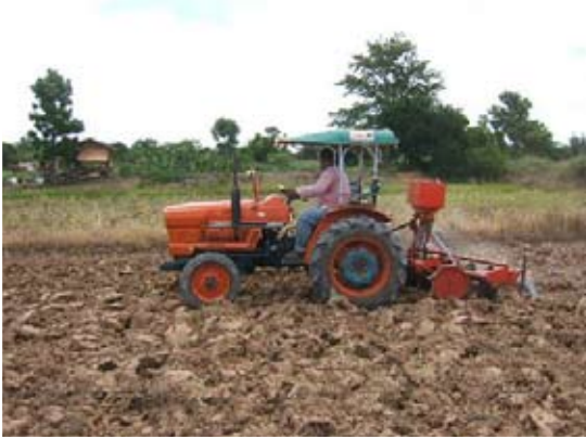
ภาพที่ 32 ใช้กับรถไถขนาด 28 แรงม้า โค้งพาล 5 จาน ยาว 125 เซนติเมตร
