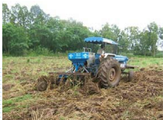
ภาพที่ 34 ใช้กับรถไถขนาด 60 แรงม้า โค้งพาลเหลี่ยม 7 จาน ยาว 180 เซนติเมตร
