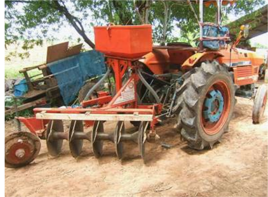
ภาพที่ 27 ใช้กับรถไถขนาด 28 แรงม้า ไครงพาล 5 จาน ยาว 125 เซนติเมตร
