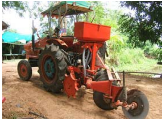
ภาพที่ 32 ใช้กับรถไถขนาด 28 แรงม้า โค้งพาล 5 จาน ยาว 125 เซนติเมตร
