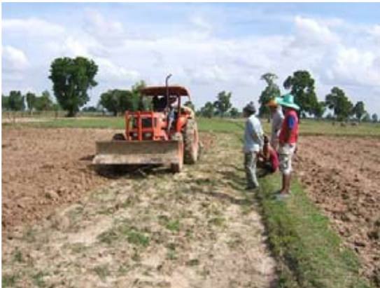
ภาพที่ 29 ใช้กับรถไถขนาด 50 แรงม้า โค้งพาล 6 จาน ยาว 150 เซนติเมตร
