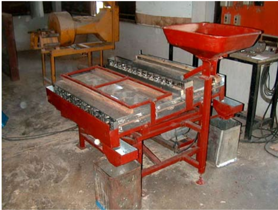
รูปที่ 4 ต้นแบบเครื่องคัดแยกข้าวเปลือกจากข้าวกล้อง
