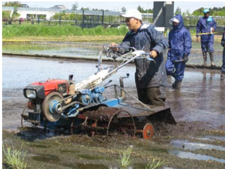
รูปที่ 4 ขลุบหมุนติดพ่วงรถไถเดินตามที่ใช้กันอย่างแพร่หลายในต่างประเทศ
