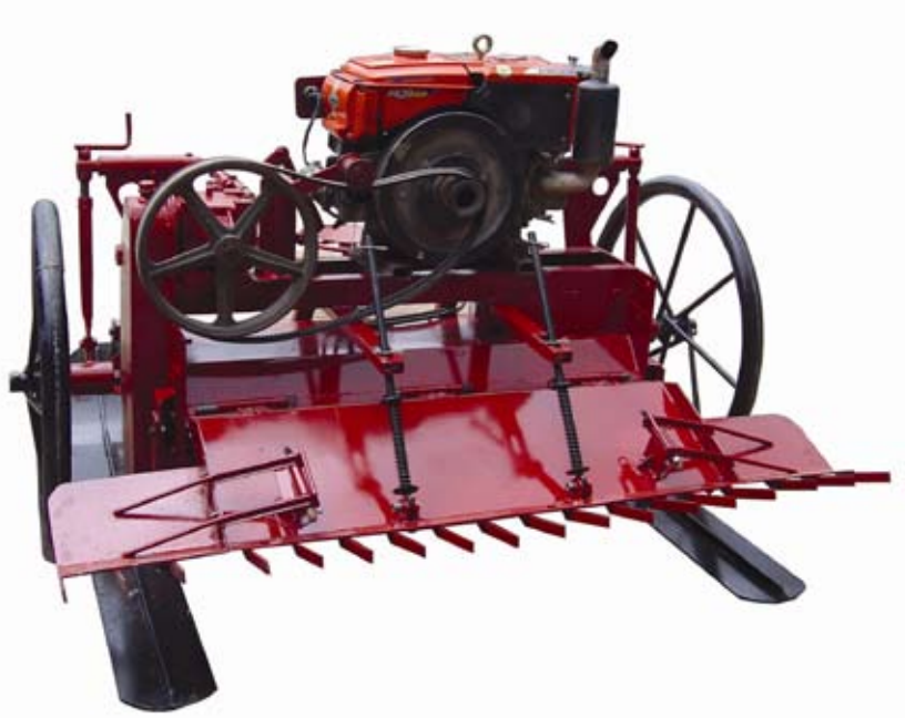
รูปที่ 9 ภาพด้านหลังขลุบหมุนพ่วงรถไถเดินตาม
