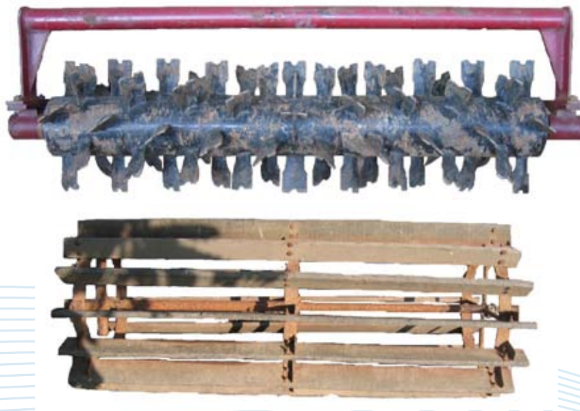
รูปที่ 3 ลักษณะของลูกจิ้ม (บน) และ ขลุบไม้ (ล่าง)
