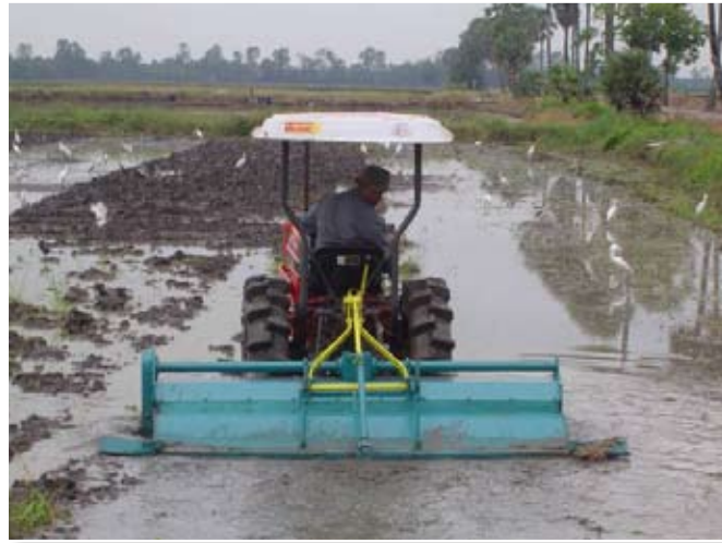
รูปที่ 5 การทดสอบดินแบบขลุบหมุนเตรียมดินชั้นที่สองสำหรับรถแทรกเตอร์ขนาดเล็ก
