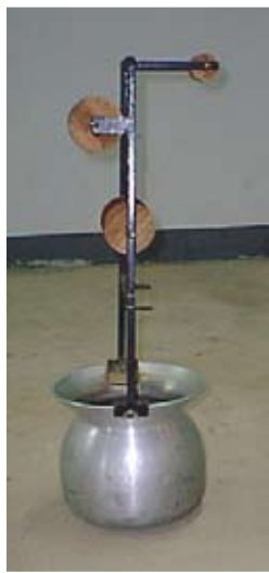
รูปที่ 6 เครื่องสาวไหมเด่นชัย 1 (ก) และการสาวเส้นไหมด้วยเครื่องสาวไหมเด่นชัย 1 (ข)
