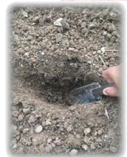
ขุดหลุมเป็นรูปตัววี เก็บตัวอย่างดิน ที่ระดับความลึก 15-20 เซนติเมตรจากผิวดิน
