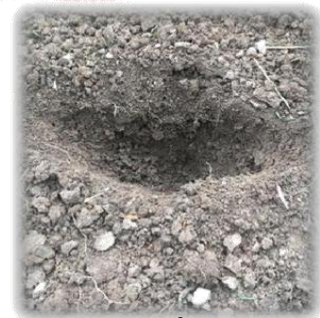
ขุดหลุมเป็นรูปตัววี เก็บตัวอย่างดิน ที่ระดับความลึก 15-20 เซนติเมตรจากผิวดิน
