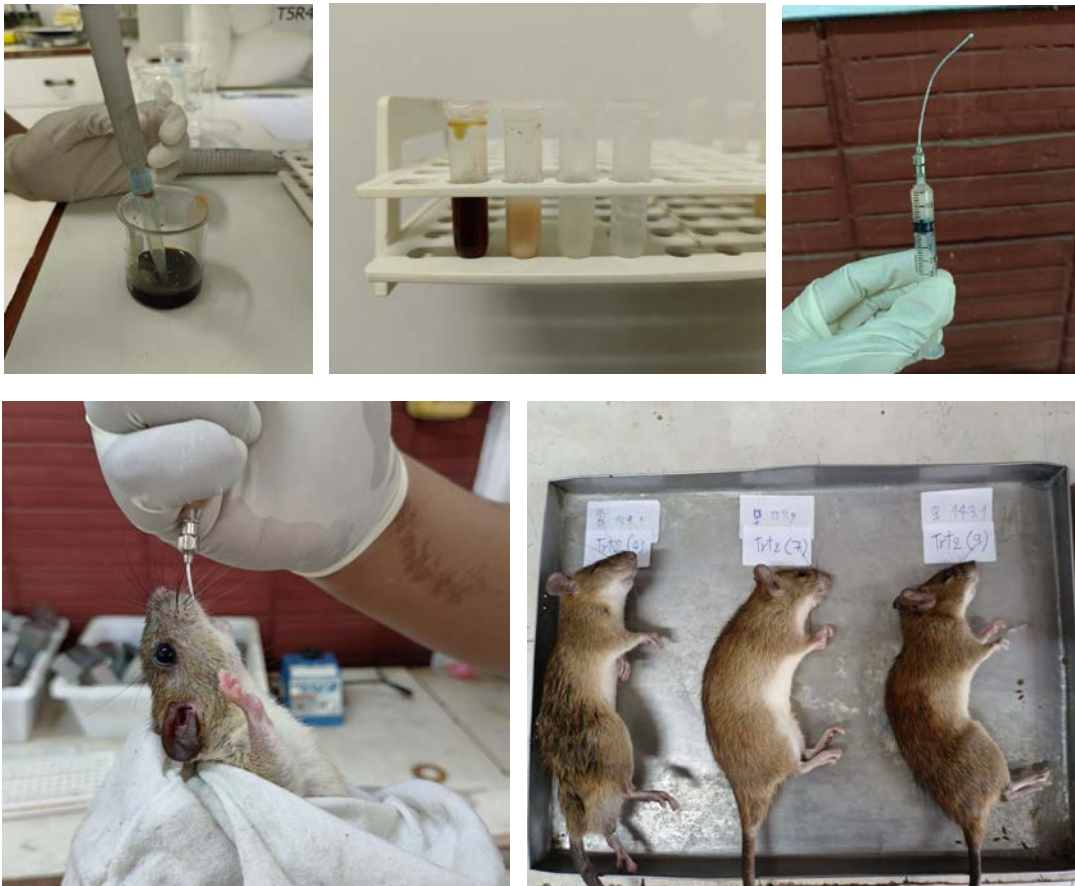
ภาพที่ 2 การทดสอบประสิทธิภาพเบื้องต้น (Screening test) ของสารโรติโนนกับหนูท้องขาวบ้าน โดยการให้สารทางปาก
