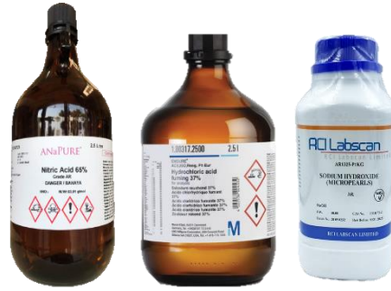
(ค) สารละลายกรดไฮโดรคลอริก กรดไนตริก และโซเดียมไฮดรอกไซด์ เพื่อปรับค่าความเป็นกรดและด่างของน้ำ
