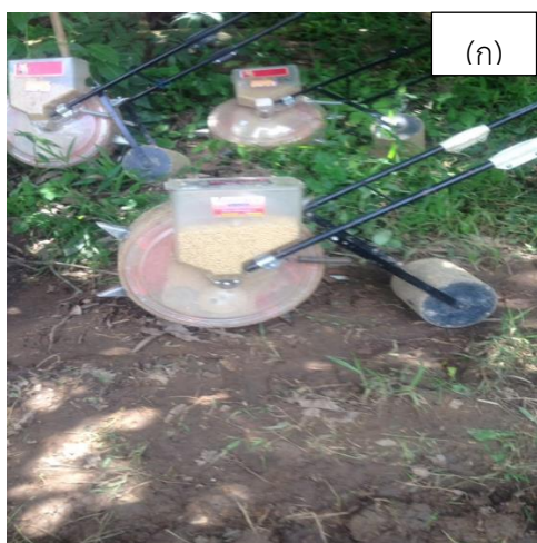
ภาพที่ 11 การปลูกถั่วเหลือง (ก) เครื่องปลูกถั่วเหลืองแบบล้อจักร (ข) การปลูกถั่วเหลืองโดยใช้เครื่องปลูกถั่วเหลืองแบบล้อจักร
