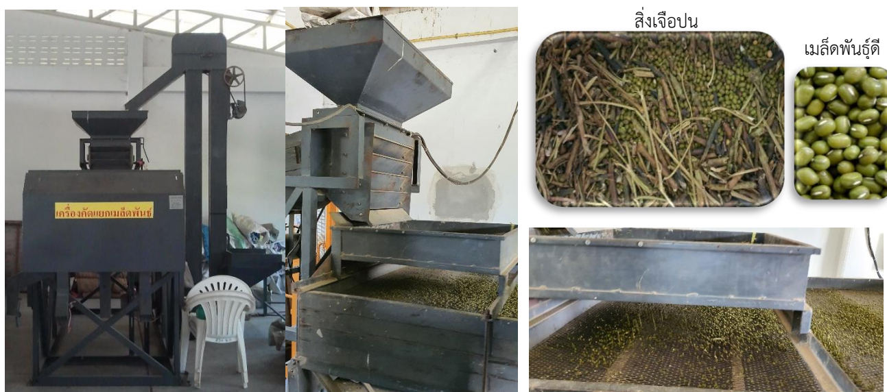
ภาพที่ 51 การปรับปรุงสภาพด้วยเครื่องคัดแยกแบบตะแกรงและแรงลม
