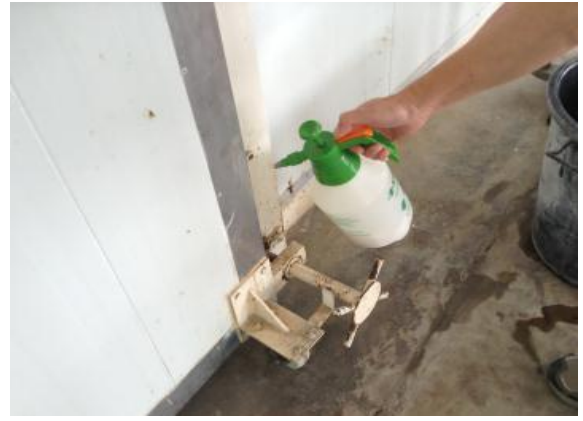
ภาพที่ 5.1 ขวดสเปรย์ภายในบรรจุสารละลายแอมโมเนียเพื่อใช้ทดสอบการรั่วของก๊าซ กรณีห้องรมใช้ก๊าซซัลเฟอร์ไดออกไซด์จากถังโดยตรง (ทีมา จักรพงษ์, 2560)
