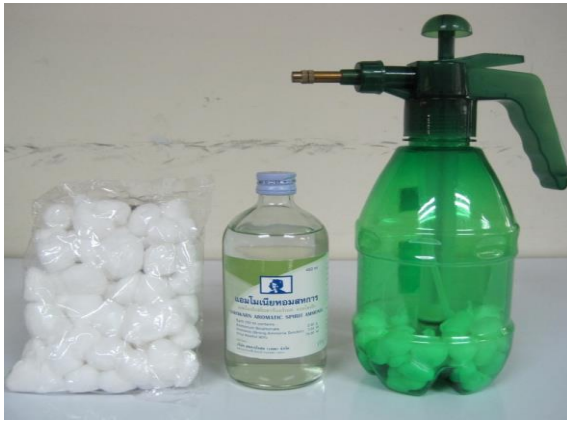
ภาพที่ 5.1 ขวดสเปรย์ภายในบรรจุสารละลายแอมโมเนียเพื่อใช้ทดสอบการรั่วของก๊าซ กรณีห้องรมใช้ก๊าซซัลเฟอร์ไดออกไซด์จากถังโดยตรง (ทีมา จักรพงษ์, 2560)
