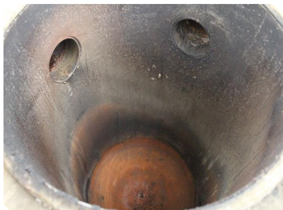
ภาพ 3.5 เตาเผาผงกำมะถันทำด้วยเหล็กปลอดสนิมหรือสแตนเลสสตีล
