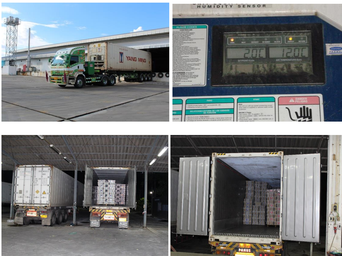
ภาพที่ 1.4 รถบรรทุกตู้คอนเทนเนอร์ที่สามารถควบคุมอุณหภูมิได้ที่ 2 องศาเซลเซียส
