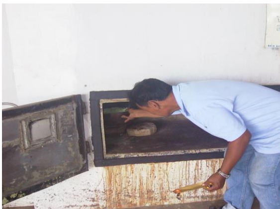
ภาพ 3.6 เตาเผาผงกำมะถันโครงสร้างก่ออิฐฉาบปูน
