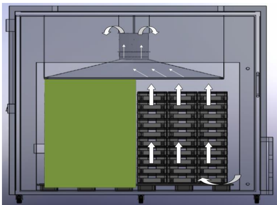
ภาพที่ 3.12 การจัดเรียงพาเลทในห้องรมระบบหมุนเวียนอากาศแบบบังคับแนวตั้ง รมด้วยก๊าซซัลเฟอร์ไดออกไซด์จากถังอัดความดันโดยตรง (ที่มา จักรพงษ์, 2560)
