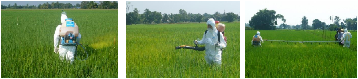
รูปที่ 1 เครื่องพ่นสารที่ใช้ในการทดลอง (ก) เครื่องยนต์พ่นสารสะพวยหลัง แบบแรงดันน้ำสูงชนิด (Motorized hydraulic knapsack sprayer) ประกอบกันฉีดแบบปรับมุมพ่นที่ด้านท้าย (Spray lance) (ข) เครื่องยนต์พ่นสารสะพวยหลังแบบใช้แรงลม (Motorized Knapsack mist-blower sprayer) และ (ค) เครื่องยนต์พ่นสารสะพวยหลัง แบบแรงดันน้ำสูงชนิด ประกอบคานหัวฉีดอลูมิเนียม (Boom sprayer) ขนาด 4 เมตร ที่พัฒนาโดยกลุ่มงานวิจัยการ ใช้น้ำป้องกันกำจัดศัตรูพืช
