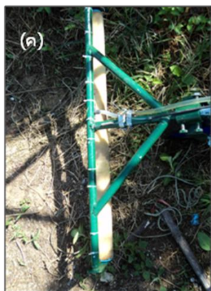
ภาพที่ 2 ต้นแบบเครื่องลูบวัชพืช 3 แบบ คือ ใช้ผ้าเช็ดเท้า (ก) ใช้ผ้ามีอบที่ปับริ้ว (ข) และลูกกลิ้งทาสี (ค)
