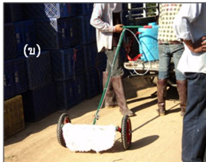
ภาพที่ 2 ต้นแบบเครื่องลูบวัชพืช 3 แบบ คือ ใช้ผ้าเช็ดเท้า (ก) ใช้ผ้ามีอบที่ปับริ้ว (ข) และลูกกลิ้งทาสี (ค)
